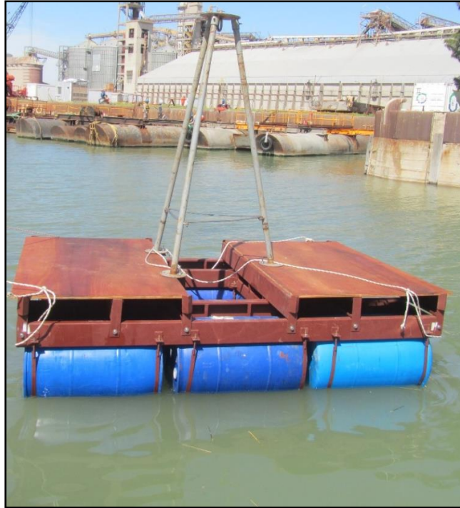
Figura II-4: Plataforma de muestreo desarrollada en el Centro Científico Tecnológico-Bahía Blanca (CCT-Bahía Blanca).
