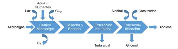
**Figura 2.1.** Etapas del proceso de producción de biodiesel a partir de microalgas. Fuente: Arias Peñaranda *et al.* (2013)
