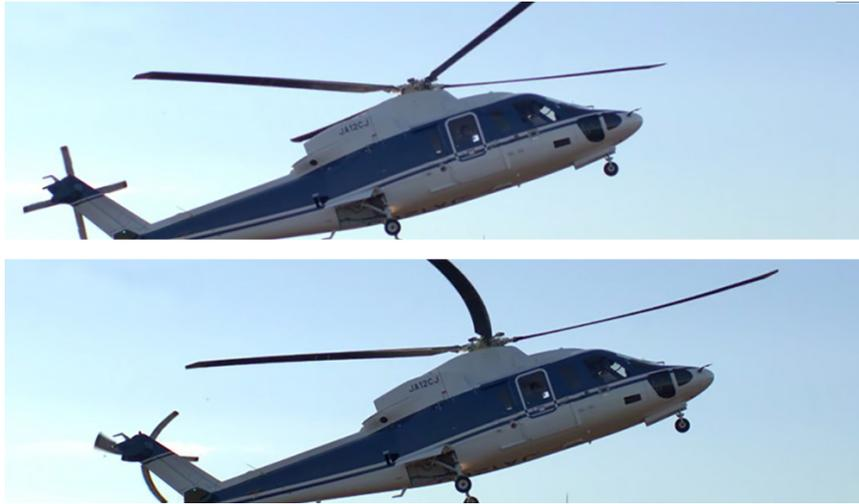
FIGURA 6.4: Efecto de rolling shutter. La imagen superior fue capturada por una cámara global shutter. La imagen inferior, por el contrario, fue obtenida utilizando una cámara rolling shutter. Se puede observar la distorsión causada por la captura de píxeles en instantes diferentes, particularmente en los objetos con movimientos rápidos como son las aspas del helicóptero
