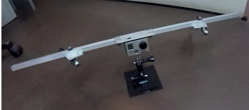
FIGURA B.2: Imagen del sistema cámara-láser utilizado para la validación experimental
