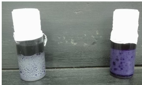
Figura 3.15. Mezclas metanol-FAME-catalizador (izquierda) y metanol-aceite-catalizador (derecha) 30 minutos después de finalizar la agitación. Relación molar metanol/aceite: 30, carga de catalizador: 3 %.
