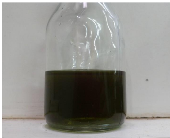
Figura 4.4. Biodiésel obtenido a partir de la reacción entre el aceite de orujo crudo y metanol.
