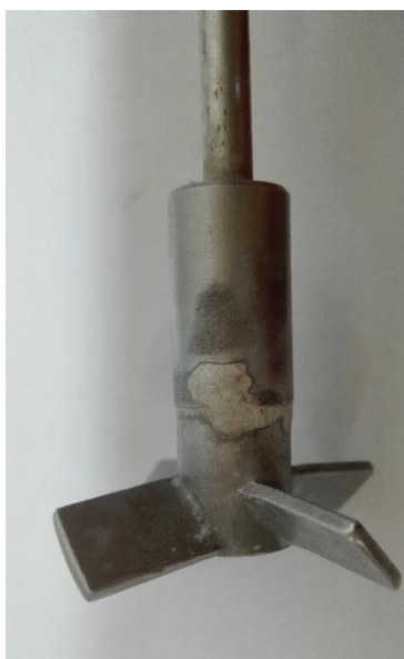
Figura 2.2. Agitador de 4 paletas inclinadas utilizado en el reactor Parr.
