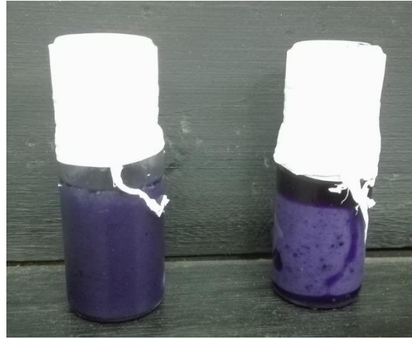
Figura 3.13. Mezclas metanol-FAME-catalizador (izquierda) y metanol-aceite-catalizador (derecha) inmediatamente después de detenerse la agitación. Relación molar metanol/aceite: 30, carga de catalizador: 3 %.
