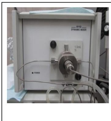
Figura 3.7. Mezclador dinámico
