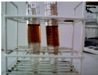
**Figura 3.2. Separación de fases en tubos.**
