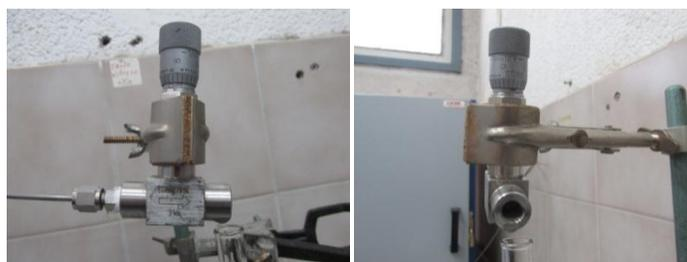
**Figura 3.9. Válvula de micro-regulación.**
