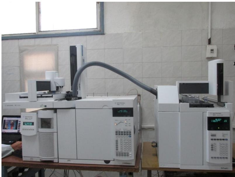
**Figura 3.12. Sistema de detección por headspace acoplado a cromatógrafo gaseoso con detector FID.**
