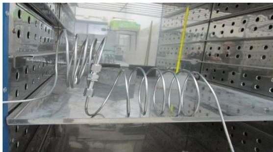
**Figura 3.8. Tubo reactor de acero inoxidable**
