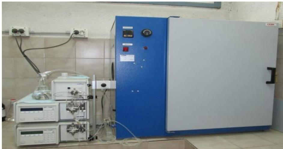
**Figura 3.5. Dispositivo experimental de partición en flujo continuo**
