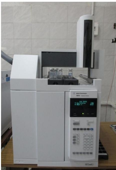
**Figura 3.18. Muestreador Headspace Agilent 7697A**
