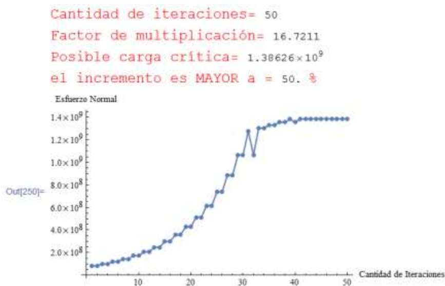
Figura 7.11 Gráfico donde se muestra de que manera, indirectamente, es posible encontrar el valor de la carga crítica en el marco cerrado [1].
