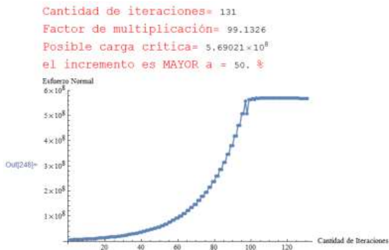
Figura 7.8 Gráfico donde se muestra de que manera, indirectamente, es posible encontrar el valor de la carga crítica.
