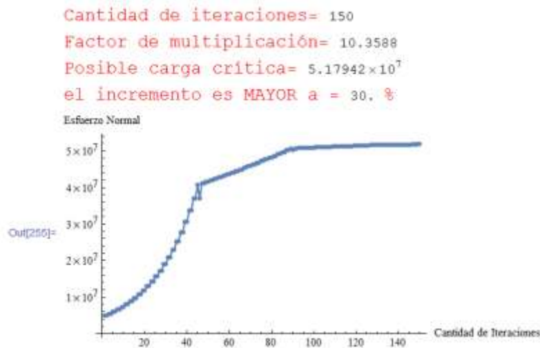
Figura 7.5 Gráfico donde se muestra de que manera, indirectamente, es posible encontrar el valor de la carga crítica [1].
