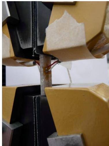
Fig. 32 Probeta de tracción (T) montada en mordazas.
