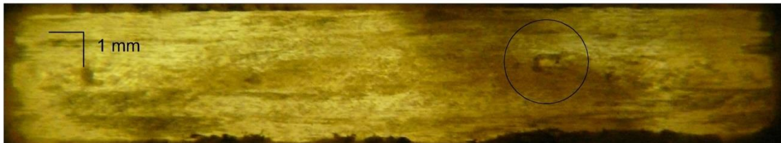
Fig. 55 Indicación de un poro en la superficie de una probeta con Unifilo ensayada.
