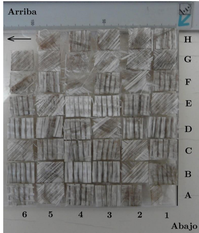
Fig. 44 Fotografía del lay-up de la muestra 2 luego de ser incinerada.
