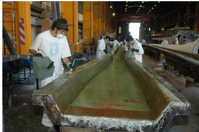
Fig. 27 Fabricación de la viga central de una pala de aerogenerador en las instalaciones de IMPSA Wind.
