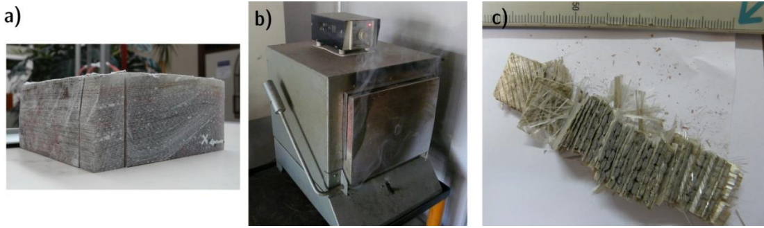
Fig. 31 Fotografías de a) corte de una muestra antes ser incinerada, b) muestra en el horno y c) muestra incinerada.
