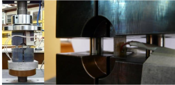
Fig. 33 Probetas de compresión (C) montadas en el dispositivo de ensayo.
