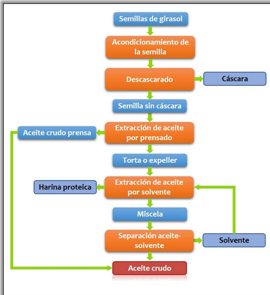
**Figura 1.11.** Diagrama de flujo del proceso industrial extracción aceite de girasol.
