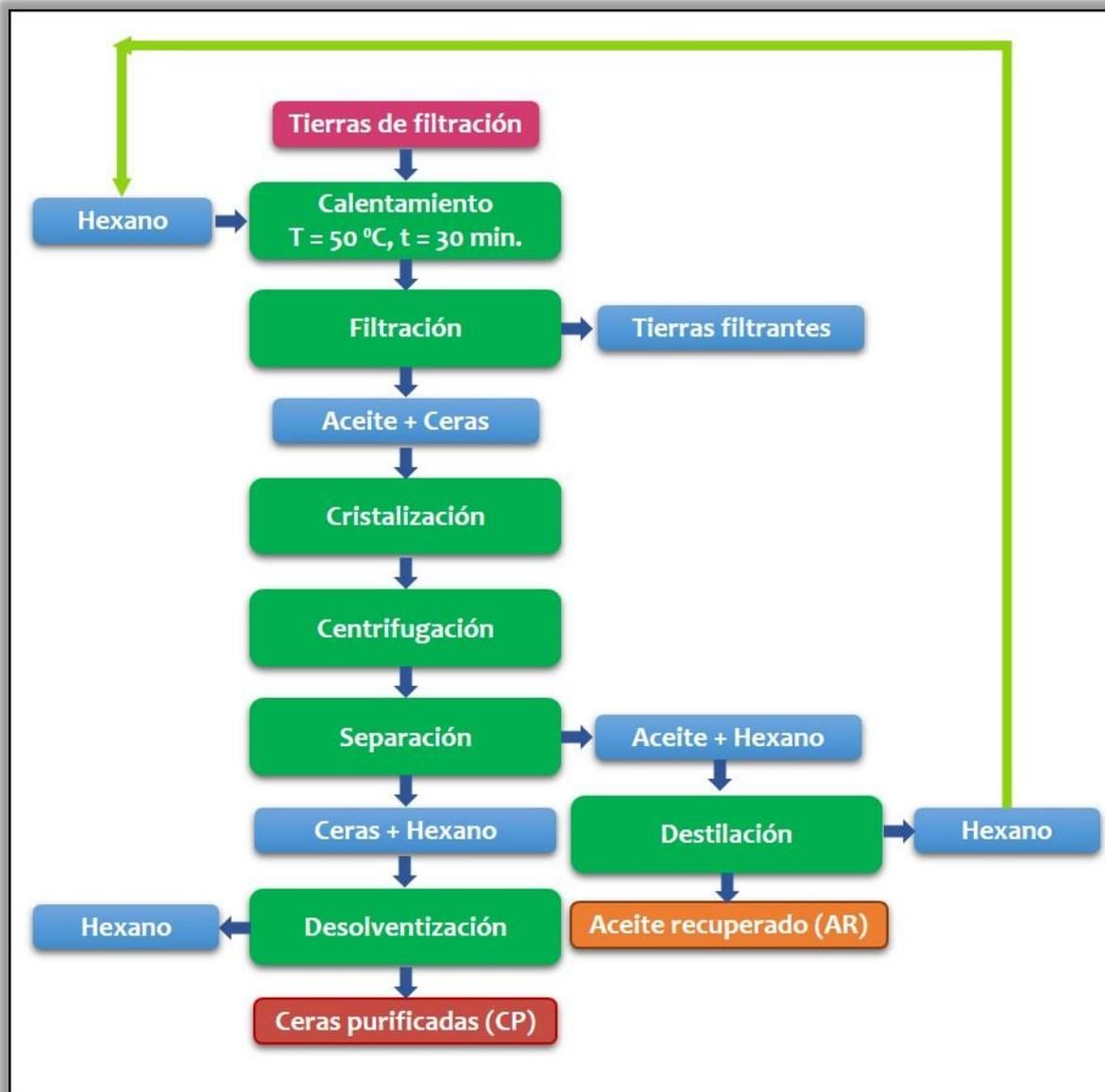
**Figura 2.1.** Diagrama de flujo fraccionamiento muestra de desecho y recuperación de ceras de girasol.
