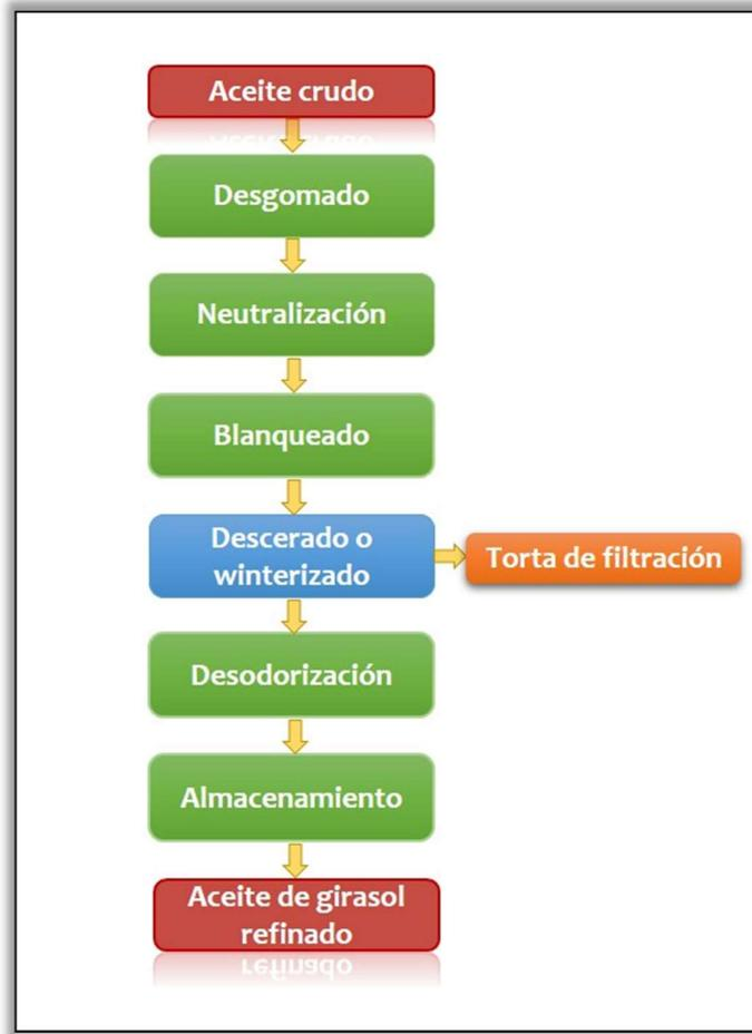
**Figura 1.12.** Diagrama de flujo del proceso de refinación del aceite de girasol.
