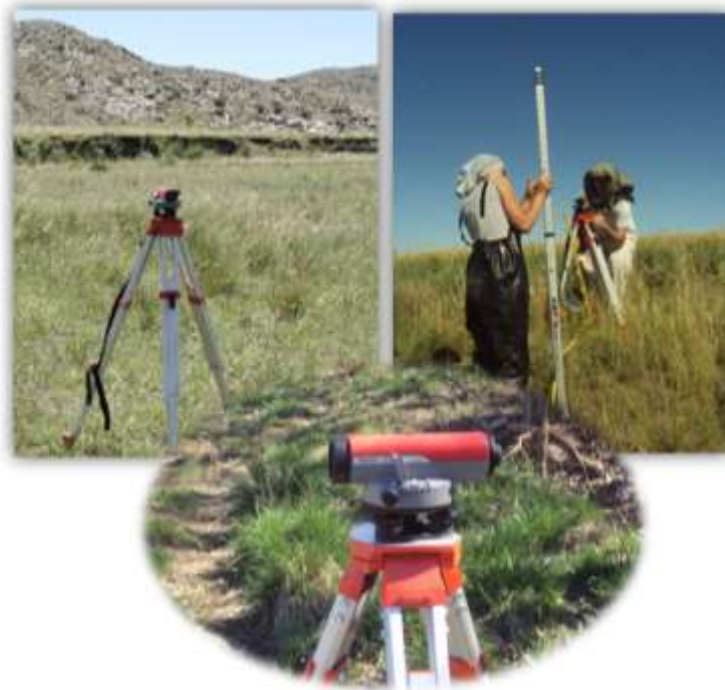
Figura 3.9. Levantamiento de perfiles transversales. Fuente: fotografía de Volonté (2013; 2015)
