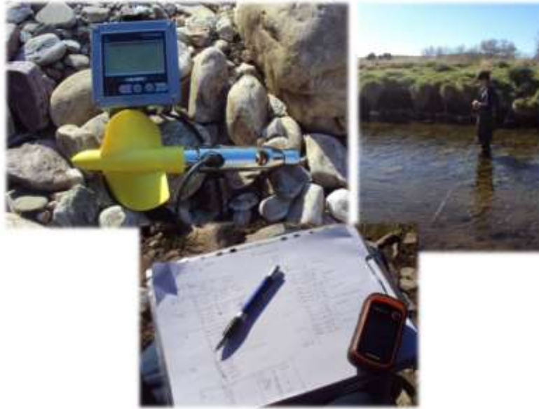
Figura 3.7 Correntómetro TECMES TS 1001 y aforo de un sector del canal principal.
