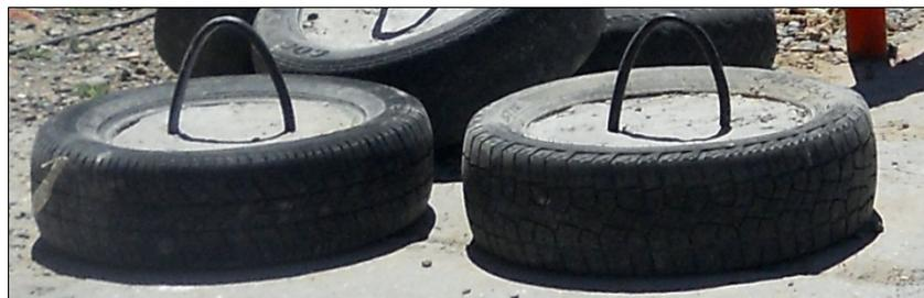
Figura 32: Fotografía de los fondeos utilizados para la línea.
