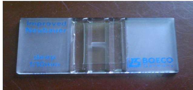
Figura 4. Cámara de Neubauer.
