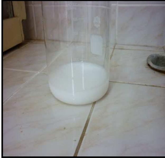
***Figura 3.1: Aspecto macroscópico de la precipitación con etanol de oligoquitosanos.***
