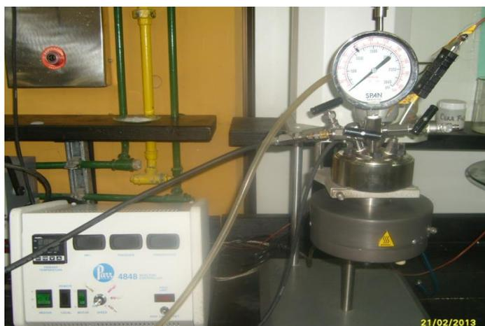
**Figura 6.1:** Reactor empleado en el tratamiento posterior de los líquidos de pirólisis.
