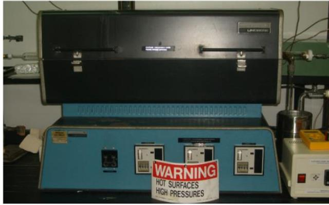
**Figura 3.2:**Equipo de pirólisis utilizado en Plapiqui.
