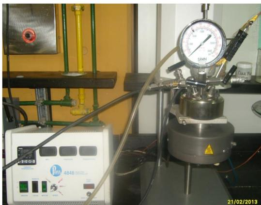
Figura 2: Reactor utilizado para el hidrot ratamiento.
