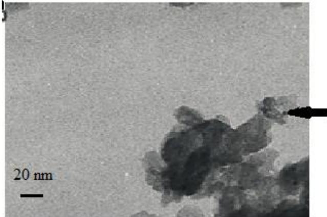
**Figura 4.26.** Imagen TEM del catalizador Pt/Nb<sub>2</sub>O<sub>5</sub> (la flecha señala la partícula de Pt)
