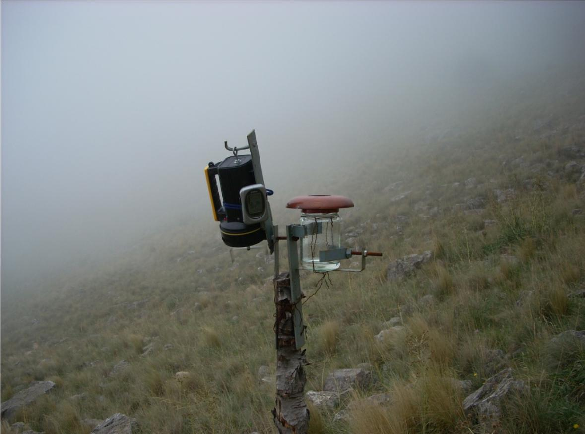
Figura 16: Muestreadores volumétrico y gravimétrico sobre poste de 1.5 m.
