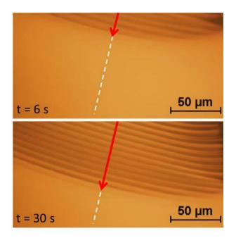
**Figura VI.7.** Propagación de un frente de inestabilidades elásticas generadas por la difusión de solvente. La posición del frente en función del tiempo permite establecer la velocidad de propagación del mismo. Observar en la figura la fuerte selectividad de escala de las arrugas (propagación con longitud de onda constante).
