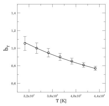
**Figura A.4.** Factor de ajuste en la dirección vertical  $b_T$  en función de la temperatura absoluta.  $T_0 = 333$  K. Símbolo: (O) Datos experimentales. La línea solida corresponde al ajuste dado por  $b_T = T_0/T$ .
