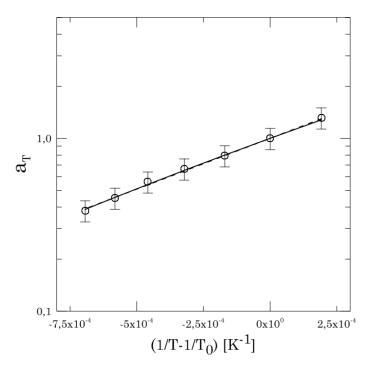
**Figura A.3.** Factor de ajuste en la dirección horizontal  $a_T$  en función de la inversa de la temperatura absoluta.  $T_0 = 333$  K. Símbolo: (O) Datos experimentales. La línea solida corresponde al ajuste mediante la ecuación WLF (ec. A.13) y la línea punteada al ajuste obtenido mediante la ecuación tipo Arrhenius (ec. A.12).
