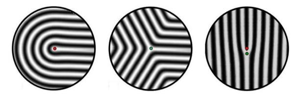
**Figura VI.11.** Defectos típicos en patrones de simetría esméctica. Izquierda: disclinación positiva de carga +1/2. Centro: disclinación negativa de carga -1/2. Derecha: dislocación. Este último defecto es menos energético que las disclinaciones dado que solo rompe el orden traslacional.
