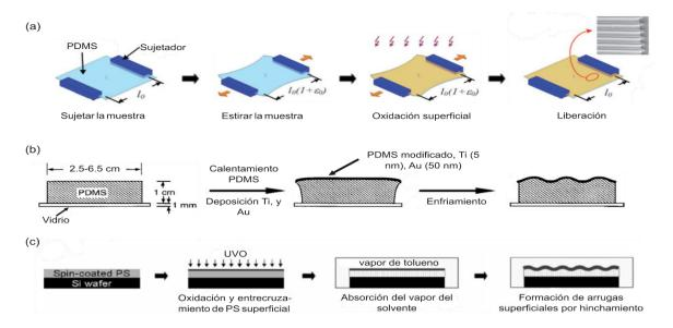
Figura II.11. Métodos de formación del campo compresivo. (a) Formación de arrugas en PDMS oxidado, mediante un sistema mecánico (estiramiento/libera-ción) [110]. (b) Inestabilidades elásticas inducidas por cambio térmico en un sistema bicapa de Au soportado en PDMS [84]. (c) Formación de arrugas mediante hincha-miento de poliestireno (PS) oxidado mediante UVO en atmosfera de tolueno [97].
