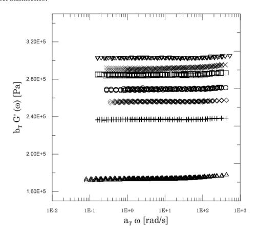
**Figura V.2.** Módulo de almacenamiento (G') en función de la frecuencia ( $\omega$ ),  $T_0 = 333$  K. Redes preparas con diferentes funcionalidades del punto de entrecruzamiento f con 10 wt.% de cadenas sueltas ( $B_0$ ) incluidas en la mezcla reactiva. Símbolos:  $\Delta f = 3,00$ , + f = 3,10,  $\Diamond f = 3,25$ ,  $\bigcirc f = 3,40$ ,  $\square f = 3,60$ ,  $\times f = 3,75$  y  $\nabla f = 4,00$ .
