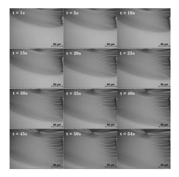
Figura VI.5. Evolución de la propagación del frente de inestabilidades elásticas en función del tiempo, en sistemas compuestos por redes modelo de PDMS/Au. Imágenes obtenidas por microscopia óptica con aumento 40x para la muestra 00-F4-100.
