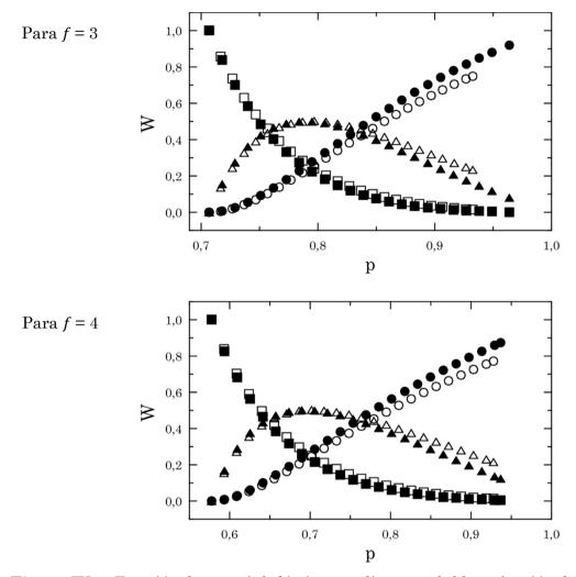
**Figura IV.1.** Fracción de material elástico, pendiente y soluble en función del avance de reacción en redes modelo de PDMS. Los símbolos vacíos y llenos representan las redes modelo con 10 wt.% de  $B_1$  y sin defectos, respectivamente. Símbolos:  $\bigcirc$   $W_E$ ,  $\triangle$   $W_P$ , y  $\square$   $W_S$ .
