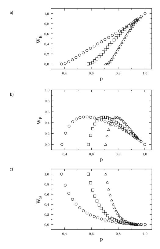
**Figura III.2.** Fracción de material elástico, pendiente y soluble en función del avance de reacción en redes modelo sin defectos incluidos en la mezcla reactiva. Símbolos:  $(\triangle) f = 3$ ,  $(\Box) f = 4$ ,  $(\bigcirc) f = 8$ .
