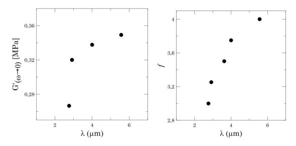
**Figura VI.16.** Módulo de almacenamiento de equilibrio a baja frecuencia para redes modelo de PDMS (izq.) y funcionalidad promedio del punto de entrecruzamiento (der.) en función de la longitud de onda de las inestabilidades elásticas generadas en las redes de PDMS recubiertas con una película de oro.
