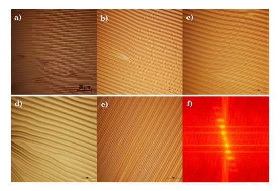
**Figura VI.15.** Imágenes de microscopia óptica de redes de PDMS recubiertas con oro hinchadas con aceite de silicona, con diferente funcionalidad de los puntos de entrecruzamiento: (a) f = 3,00, (b) f = 3,25, (c) f = 3,50, (d) f = 3,75, y (e) f = 4,00. (f) Imagen del logaritmo de la potencia espectral de la Transformada de Fourier mediante la cual se pudo calcular la longitud de onda de la red de la imagen (a).
