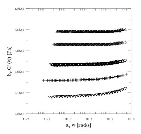
Figura IV.4. Módulo de almacenamiento (G') en función de la frecuencia ( $\omega$ ),  $T_0 = 333$  K. Redes modelo de PDMS con f = 5 y diferentes concentraciones de polímero monofuncional  $B_1$ . Símbolos:  $\triangle 0$  wt.%,  $\lozenge 1$  wt.%,  $\bigcirc 5$  wt.%, + 10 wt.% y  $\nabla 15$  wt.%.
