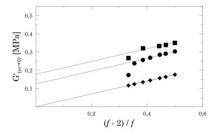
Figura V.3. Módulo de almacenamiento de equilibrio medido a bajas frecuencias  $(G'_{\omega\to 0})$  en función de (f-2)/f,  $T_0=333$  K. Redes modelo de PDMS preparas con diferentes funcionalidades del punto de entrecruzamiento f. Símbolos:  $\blacksquare$  resultados experimentales para redes sin defectos incluidos,  $\bullet$  resultados experimentales para redes con 10 wt.% de  $B_0$ , y  $\bullet$  resultados teóricos para redes modelo de PDMS.
