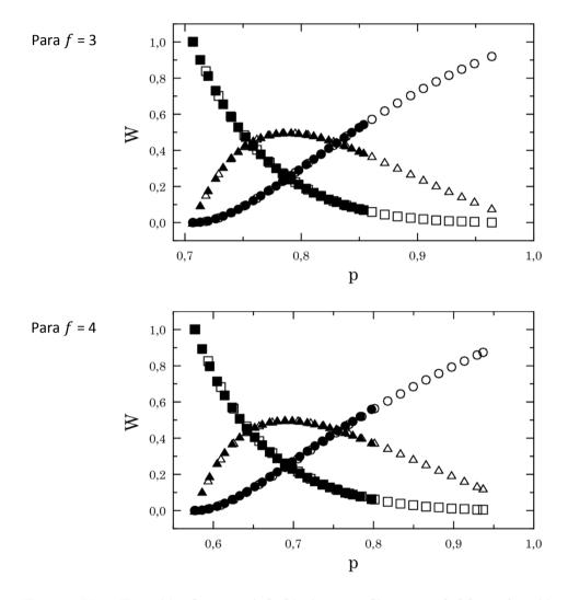
**Figura V.1.** Fracción de material elástico, pendiente y soluble en función del avance de reacción en redes modelo de PDMS. Los símbolos vacíos y llenos representan las redes modelo con 10 wt.% de  $B_0$  y sin defectos, respectivamente. Símbolos:  $\bigcirc$   $W_E$ ,  $\triangle$   $W_P$ , y  $\square$   $W_S$ .
