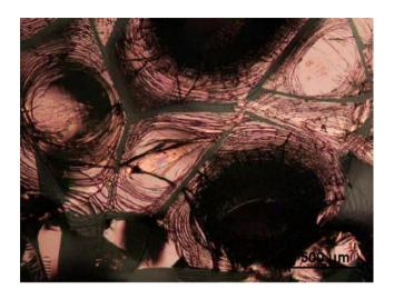
**Figura VI.4.** Hinchamiento con tolueno de sistemas compuestos por redes modelo de PDMS/Au. Imágenes obtenidas por microscopia óptica con aumento 4x para una muestra 00-F4-75.
