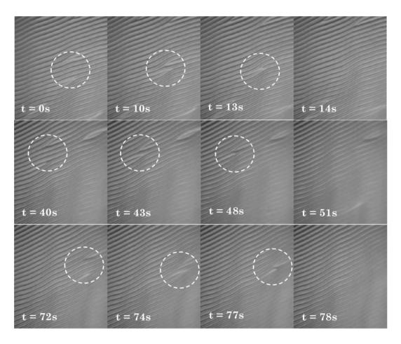
Figura VI.14. Aniquilación de dislocaciones en sistemas redes modelo de PDMS recubiertos con películas de Au. Imágenes obtenidas por microscopia óptica con aumento 100x para la muestra 00-F4-75.
