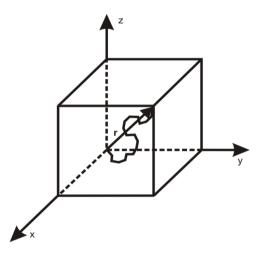
Figura II.2. Esquema de una subcadena ideal formada por N segmentos de longitud b. r representa la distancia vectorial entre los extremos de la cadena.
