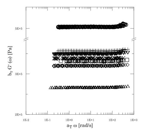
**Figura III.3.** Módulo de almacenamiento (G') en función de la frecuencia ( $\omega$ ),  $T_0 = 333\,$  K. Redes preparas con diferentes funcionalidades del punto de entrecruzamiento f sin defectos incluidos en la mezcla reactiva. Símbolos:  $\triangle f = 3,00$ ,  $\Diamond f = 3,25$ ,  $\Box f = 3,60$ ,  $\times f = 3,75$ ,  $\nabla f = 4,00$ , + f = 5,00  $y \bigcirc f = 8,00$ .
