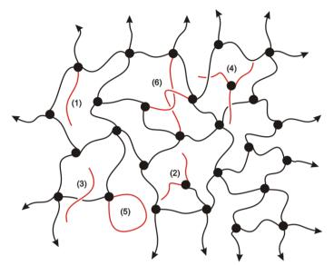
Figura II.1. Estructura molecular final de una red polimérica. Las líneas negras sólidas corresponden a las cadenas elásticamente activas, los círculos representan las uniones químicas y las flechas cadenas que conducen al gel. En el esquema se presentan también algunos defectos estructurales: cadenas pendientes lineales (1) y ramificadas (2), cadenas libres atrapadas lineales (3) y ramificadas (4), lazos (5) y entrelazamientos (6).
