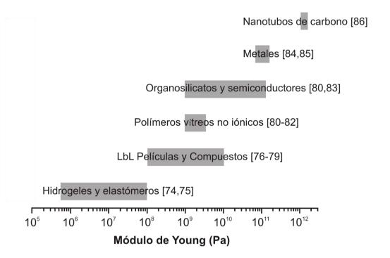
**Figura II.9.** Rango de valores del módulo de Young medido usando técnicas de arrugas superficiales como se informa en la literatura [74-86].
