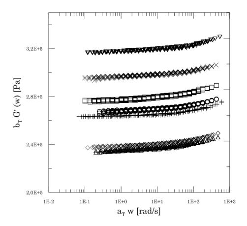
**Figura IV.3.** Módulo de almacenamiento (G') en función de la frecuencia ( $\omega$ ),  $T_0 = 333$  K. Redes preparas con diferentes funcionalidades del punto de entrecruzamiento f con 10 wt.% de cadenas pendientes (B<sub>1</sub>) incluidas en la mezcla reactiva. Símbolos:  $\Delta f = 3,00$ ,  $\Diamond f = 3,10$ ,  $\bigcirc f = 3,40$ ,  $\Box f = 3,60$ ,  $\times f = 3,75$ ,  $\nabla f = 4,00$  y + f = 5,00.
