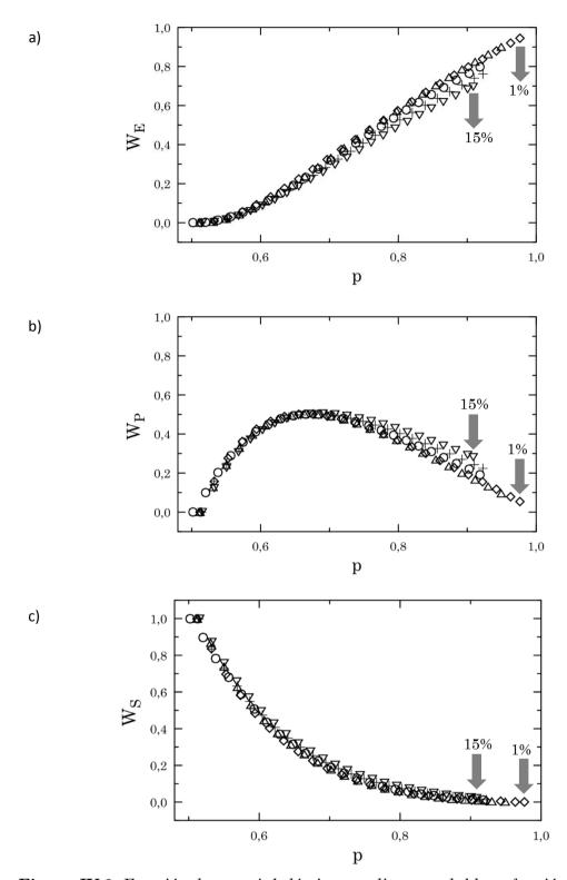
**Figura IV.2.** Fracción de material elástico, pendiente y soluble en función del avance de reacción en redes modelo de PDMS con f = 5, y diferentes concentraciones de polímero monofuncional  $B_1$ . Símbolos:  $\triangle$  0 wt.%,  $\diamondsuit$  1 wt.%,  $\bigcirc$  5 wt.%, + 10 wt.% y  $\nabla$  15 wt.%.
