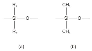
**Figura A.1.** (a) Unidad repetitiva de una molécula de polisiloxano, donde  $R_1$  y  $R_2$  representan dos grupos sustituyentes diferentes. (b) Unidad repetitiva de una molécula de poli(dimetilsiloxano) (PDMS).
