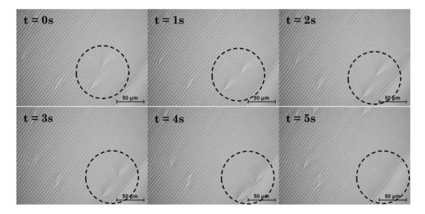
**Figura VI.13.** Expulsión de dislocaciones del sistema de inestabilidades elásticas. Imágenes obtenidas por microscopia óptica con aumento 40x para la muestra 00-F4-100.
