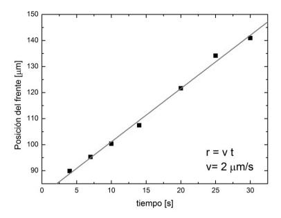
**Figura VI.8.** Posición del frente en función del tiempo. Los símbolos representan los datos experimentales mientras que el ajuste lineal permite establecer que la velocidad de propagación en este sistema es de  $2 \mu m/s$ .
