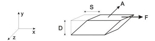
**Figura A.2.** Diagrama esquemático de los parámetros involucrados en las medidas de viscosidad de corte.
