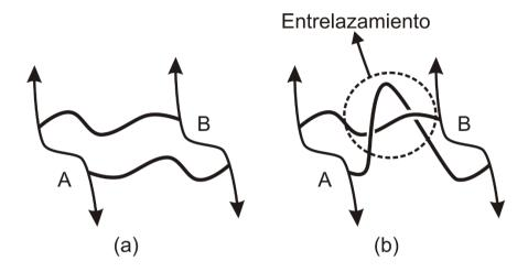
**Figura II.3.** (a) Esquema de una subcadena de la red no-entrelazada y (b) formando un entrelazamiento. Las cadenas con flechas están conectadas a la red infinita y son consideradas cadenas fijas.
