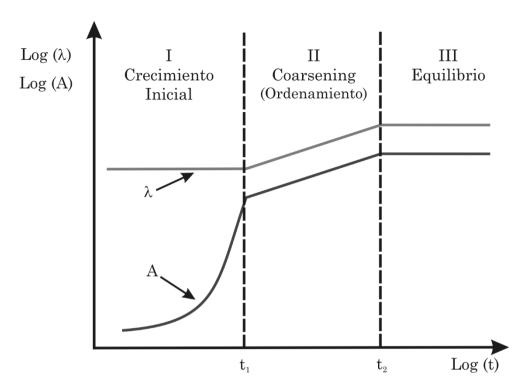
**Figura VI.6.** Ilustración esquemática de la evolución de la longitud de onda (λ) y la amplitud (A) de inestabilidades elásticas predicho por un análisis de escalado por Huang y col [8].
