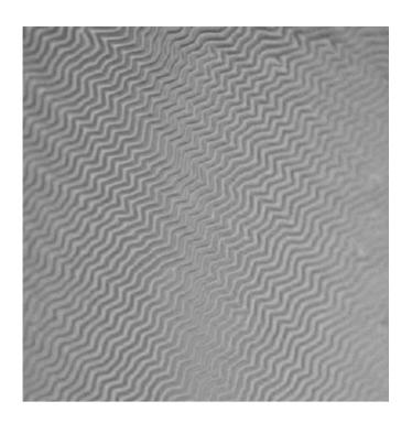
**Figura VI.10.** Morfología del choque de dos frentes de propagación conocido como Herringbones. Imágenes obtenidas por microscopia óptica con aumento 40x para la muestra 00-F4-75.
