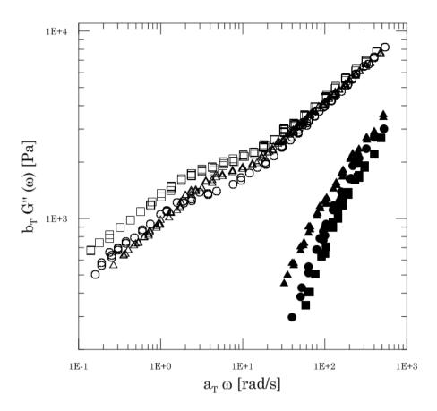
**Figura IV.5.** Módulo de pérdida (G") en función de la frecuencia ( $\omega$ ),  $T_0 = 333$  K. Redes modelo de PDMS. Los símbolos vacíos y llenos representan las redes modelo con 10 wt.% de  $B_1$  y sin defectos, respectivamente. Símbolos:  $\triangle f = 3,00$ ,  $\Box f = 3,60$ , y  $\bigcirc f = 4,00$ .
