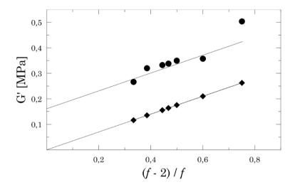
**Figura III.4.** Módulo de almacenamiento (G') en función de (f-2)/f,  $T_0 = 333$  K. Redes preparas con diferentes funcionalidades del punto de entrecruzamiento f sin defectos incluidos en la mezcla reactiva. Símbolos:  $\bullet$  resultados experimentales, y  $\bullet$  resultados teóricos.
