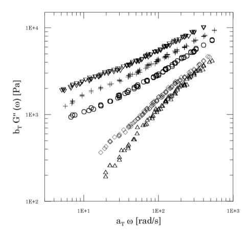
**Figura IV.6.** Módulo de pérdida (G'') en función de la frecuencia ( $\omega$ ),  $T_0 = 333$  K. Redes modelo de PDMS con f = 5 y diferentes concentraciones de polímero monofuncional  $B_1$ . Símbolos:  $\triangle 0$  wt.%,  $\lozenge 1$  wt.%,  $\bigcirc 5$  wt.%, + 10 wt.% y  $\nabla 15$  wt.%.
