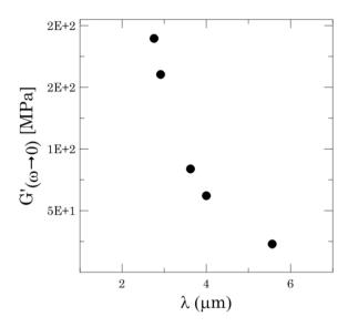
Figura VI.17. Módulo de almacenamiento de equilibrio a baja frecuencia para redes modelo de PDMS, calculado utilizando ecuación VI.1, en función de la longitud de onda de las inestabilidades elásticas generadas en las redes de PDMS recubiertas con una película de oro.
