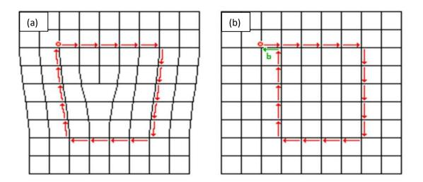
Figura VI.12. Esquema mostrando el circuito de Burgers que permite establecer la magnitud, dirección y sentido del vector de Burgers **b**. (a) sistema que contiene una dislocación. (b) red modelo donde el vector de Burgers se encuentra indicado con una flecha verde. Notar que el sentido del vector depende de la definición del sentido de rotación alrededor del circuito.
