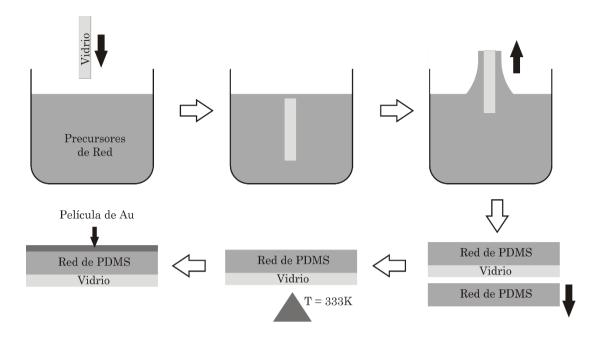
**Figura VI.1.** Proceso de fabricación del sistema PDMS/Au. Proceso de dipcoating de una lámina de vidrio en los precursores de red, se elimina el polimero de una cara del vidrio, posteriormente se realiza la reacción de curado (T = 333 K) y finalmente se realiza la deposición de oro sobre la red curada.
