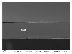
Figura VI.3. Imágenes tomadas por microscopia electrónica de barrido (SEM) para realizar la medición del espesor de la red en los sistemas PDMS/Au. En la imagen de la izquierda los espesores reportados son131,5 μm y 152 μm, en la imagen de la derecha se reporta un espesor de 148,6 μm de la red 00-F4-00.
