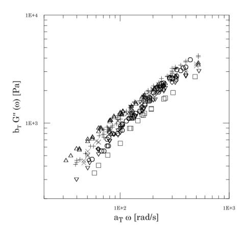
**Figura III.5.** Módulo de pérdida (G") en función de la frecuencia ( $\omega$ ),  $T_0 = 333$  K. Redes preparas con diferentes funcionalidades del punto de entrecruzamiento f sin defectos incluidos en la mezcla reactiva. Símbolos:  $\triangle f = 3,00$ ,  $\Diamond f = 3,25$ ,  $\Box f = 3,60$ ,  $\times f = 3,75$ ,  $\nabla f = 4,00$ , + f = 5,00 y  $\bigcirc f = 8,00$ .
