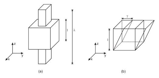
Figura II.5. (a) Extensión uniaxial y (b) Deformación de corte puro.
