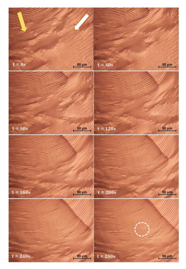
**Figura VI.9.** Propagación de frente en un sistema combinado por inestabilidades elásticas lineales y herringbones. Las flechas representan la dirección de propagación de los dos frentes. Imágenes obtenidas por microscopia óptica con aumento 40x para la muestra 00-F4-25. El circulo en la imagen correspondiente a t=280 s resalta la presencia de una dislocación.
