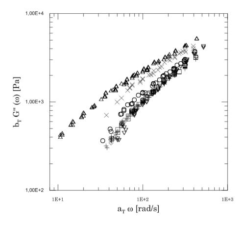
**Figura V.4.** Módulo de pérdida (G") en función de la frecuencia ( $\omega$ ),  $T_0 = 333$  K. Redes preparas con diferentes funcionalidades del punto de entrecruzamiento f con 10 wt.% de cadenas sueltas (B<sub>0</sub>) incluidas en la mezcla reactiva. Símbolos:  $\triangle f = 3,00$ , + f = 3,10,  $\Diamond f = 3,25$ ,  $\bigcirc f = 3,40$ ,  $\square f = 3,60$ ,  $\times f = 3,75$  y  $\nabla f = 4,00$ .
