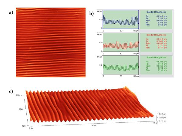
**Figura VI.18.** Imágenes de microscopia de fuerzas atómicas (AFM) de redes de PDMS recubiertas con oro hinchadas con aceite de silicona para redes 00-F4-00. a) Vista superior, área de 100x100 (μm²), b) Perfiles de altura de las inestabilidades elásticas, c) Imagen 3D del campo estudiado.
