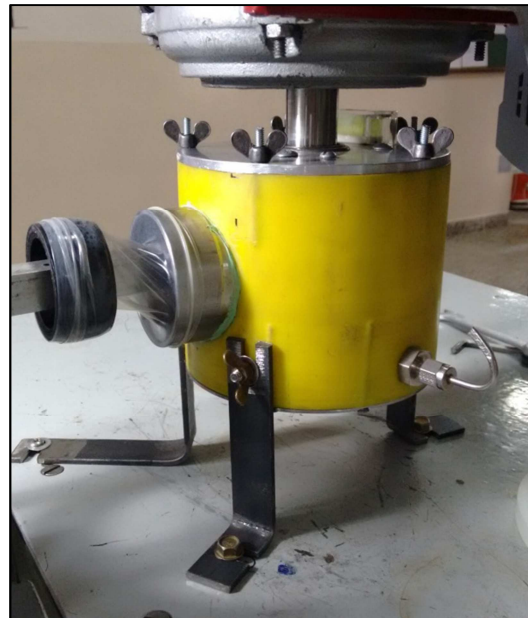
Figura 5.24. Detalle de la cámara hermética para ensayos en atmósfera controlada.
