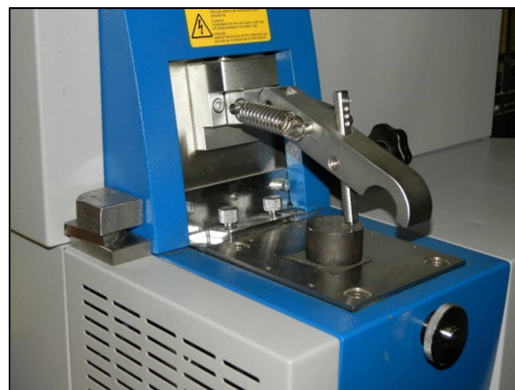
Figura 5.2. Detalle del sistema de fijación de muestras del espectrómetro.
