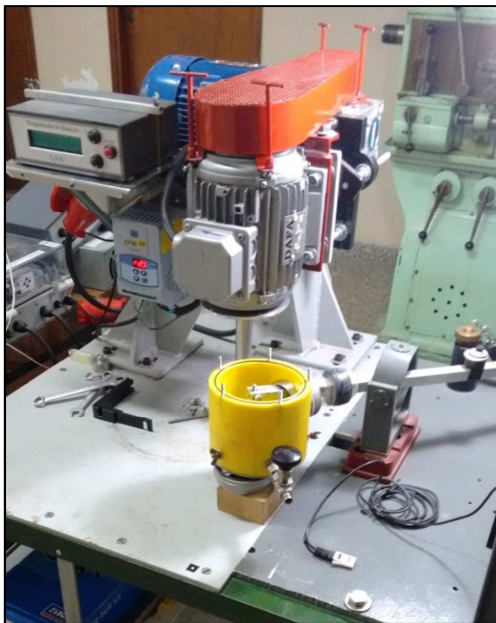
Figura 5.23. Tribómetro pin-on-disk de fabricación propia dotado de cámara hermética para realización de ensayos en atmósfera controlada.
