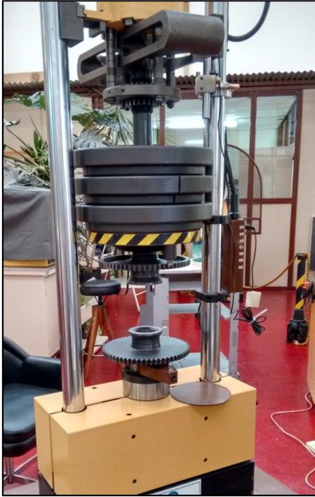
Figura 5.35. Vibróforo AMSLER adaptado para ensayos de tenacidad a la fractura. GMF-UNCOMA.
