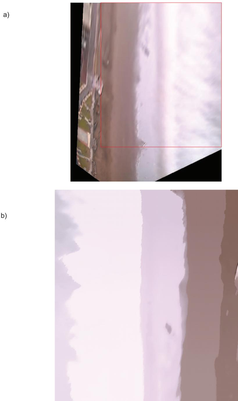
**Figura 4.5:** Aplicación del algoritmo *Mean Shift* en imágenes medias de la playa de Monte Hermoso. a) Área seleccionada sobre la imagen media. b) Resultado de aplicar el algoritmo *Mean Shift*, la diferencia entre las zonas es visualmente más distinguible.
