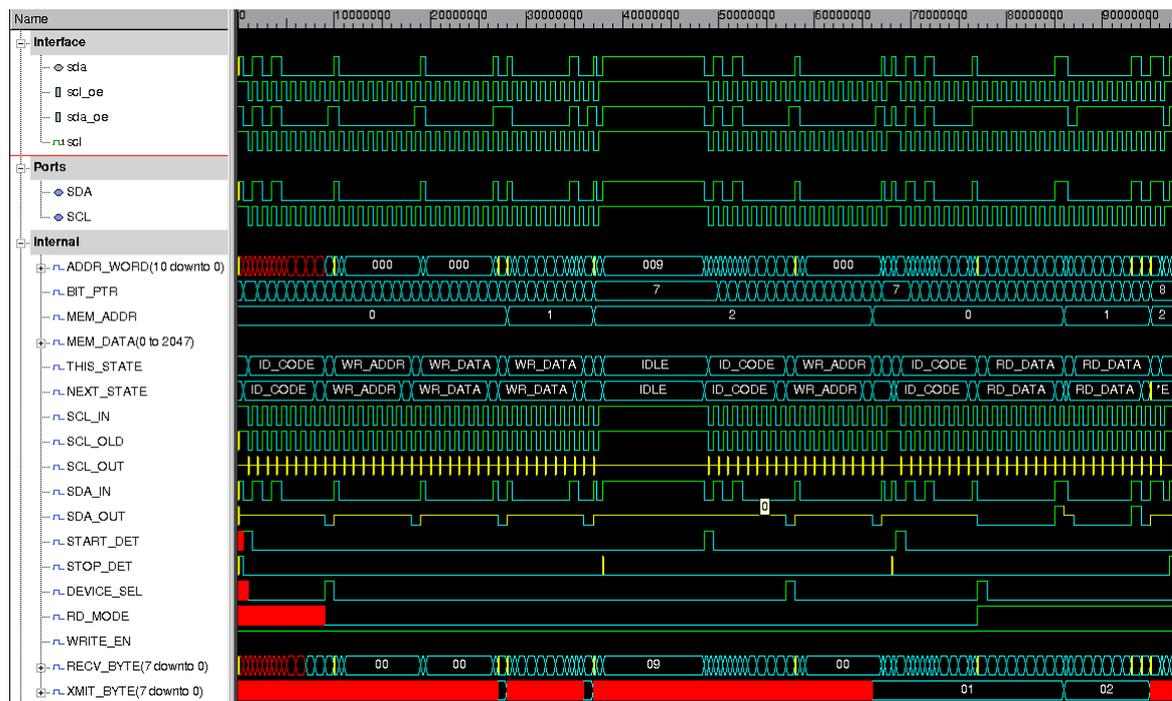
Figura 3.9: Formas de onda generadas por *Synopsys DVE* para la simulación correspondiente a la estimulación de la EEPROM I2C con la secuencia de operaciones presentada en esta subsección.
