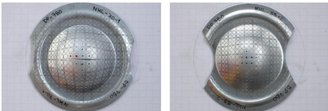
**Figura 6.7** Patrón de círculos grillados sobre la superficie de probetas Nakajima.
