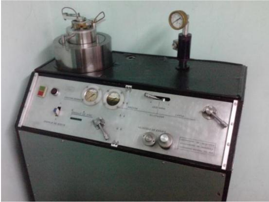
**Figura 4.3** Equipo de acopado hidráulico.
