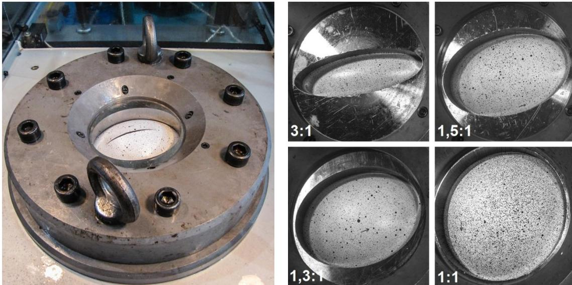
**Figura 3.5** Dispositivo de acopado hidráulico del CEMEF (izq.) y máscaras utilizadas (der.). Los números sobre cada máscara indican su relación de aspecto.
