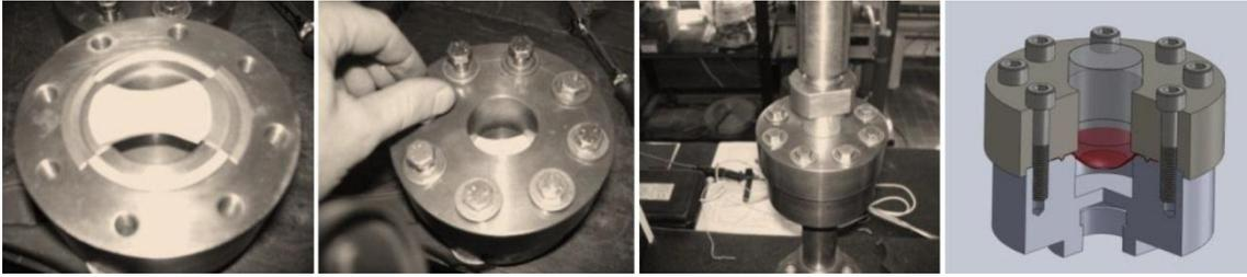
**Figura 3.7** Montaje de probetas en la matriz para el ensayo Nakajima (Serenelli, 2013).
