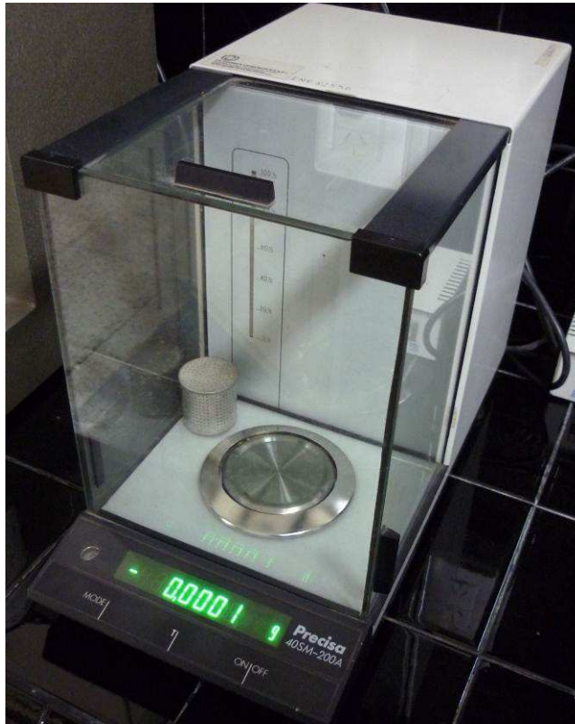
Fig. 4.19. Balanza de precisión utilizada para determinar la cantidad de lubricante.
