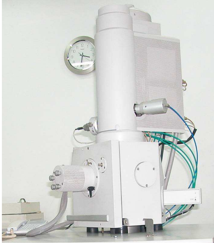
Fig. 4.5. Microscopio electrónico de barrido (SEM) marca Philips modelo XL 30 CP (REDE-AR).
