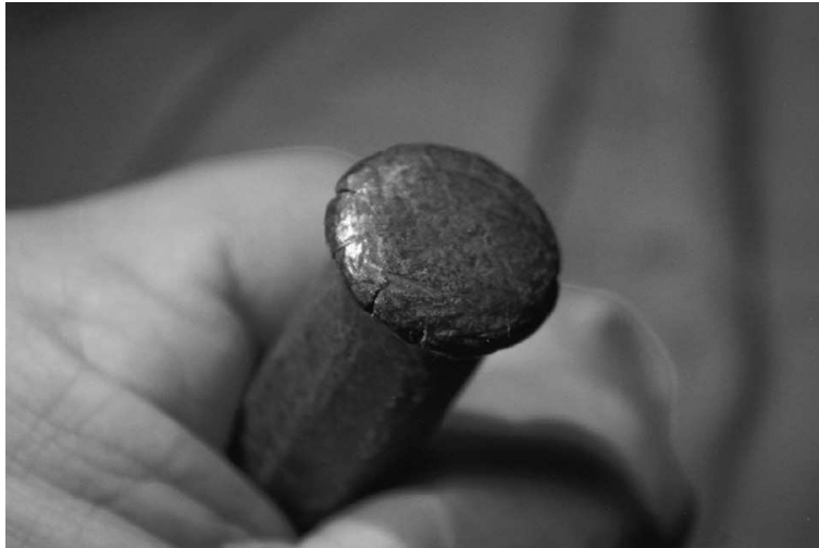
Fig. 2.22. Desgaste por impacto y deformación en una cabeza de zincel bien utilizada [32].
