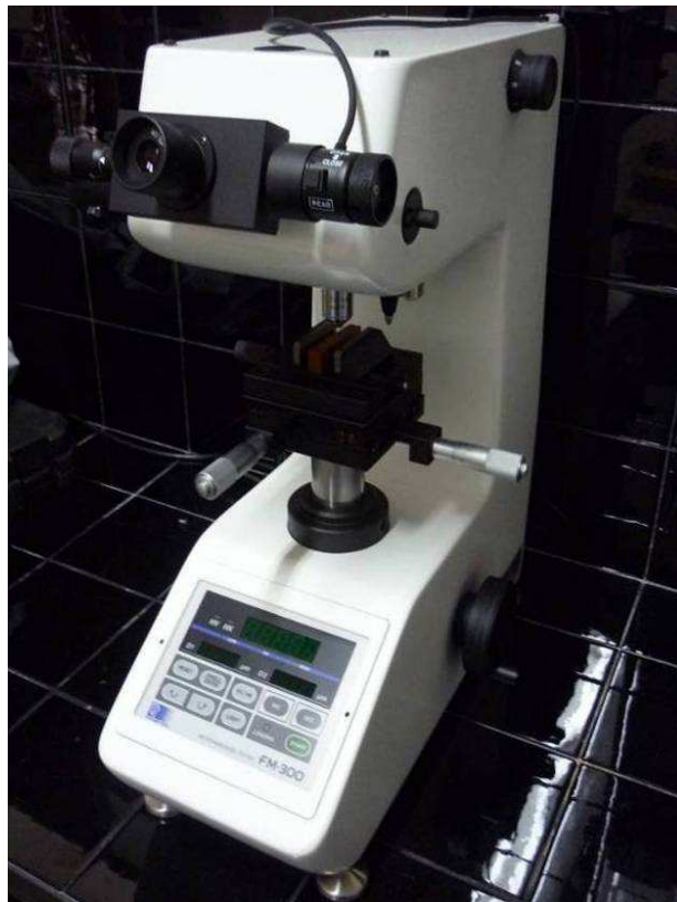
Fig. 4.25. Microdurómetro Vickers, marca Future Tech, modelo FM-300 (LEEM-UNS).
