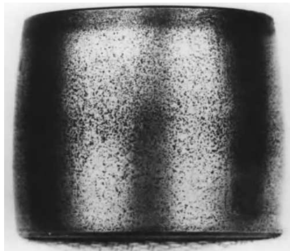
Fig. 2.18. Micrografía SEM de un rodillo de un rodamiento SAE 52100 después del desgaste corrosivo [5].
