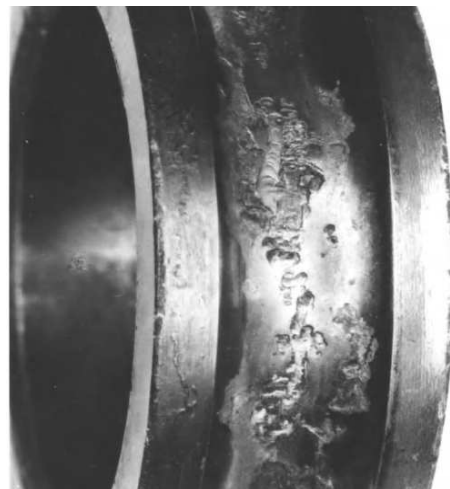
Fig. 2.17. Desprendimientos (spalling) en una pista de rodadura de un rodamiento de bolas SAE 52100 con fatiga subsuperficial [5].
