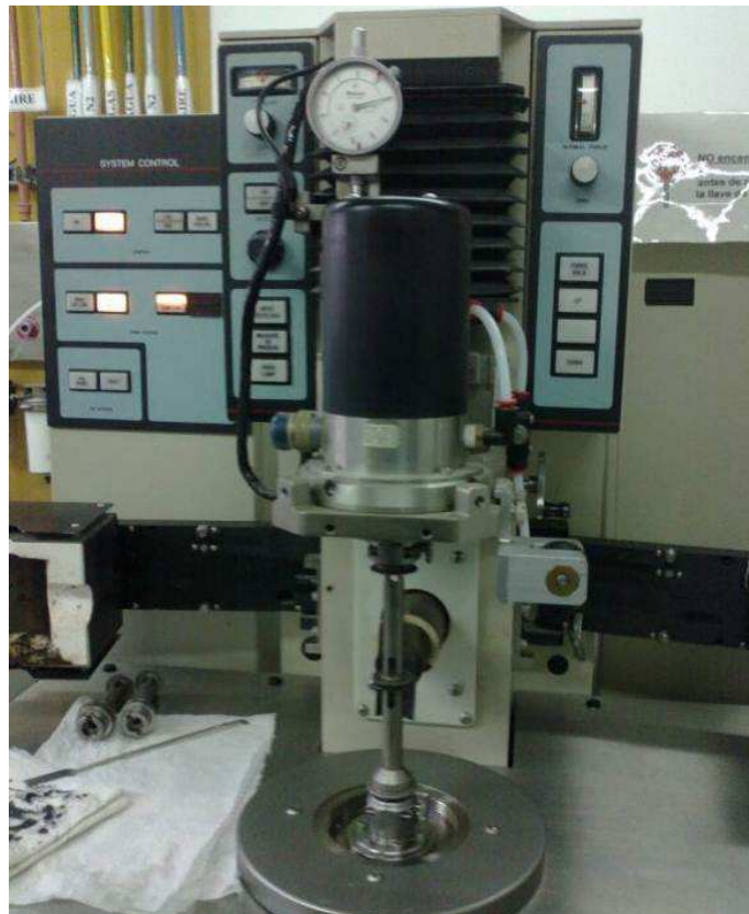
Fig. 4.3. Reómetro rotacional marca Rheometrics, modelo RDA-II (PLAPIQUI-CONICET-BB).
