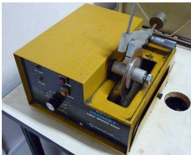
Fig. 4.24. Cortadora de precisión marca Buehler, modelo IsoMet Low Speed Saw (LEEM).
