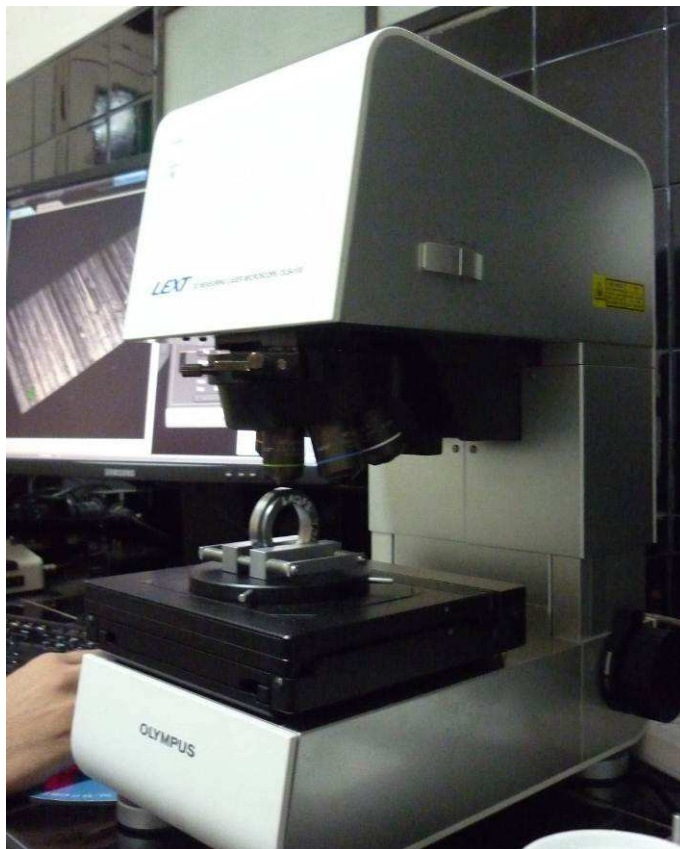
Fig. 4.6. LSCM marca OLYMPUS modelo LEXT OLS4100.
