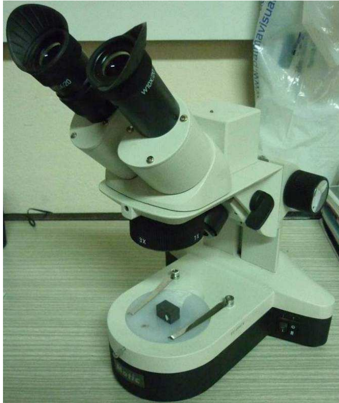
Fig. 4.22. Lupa Motic con cámara incorporada utilizada para la medición de desgaste.
