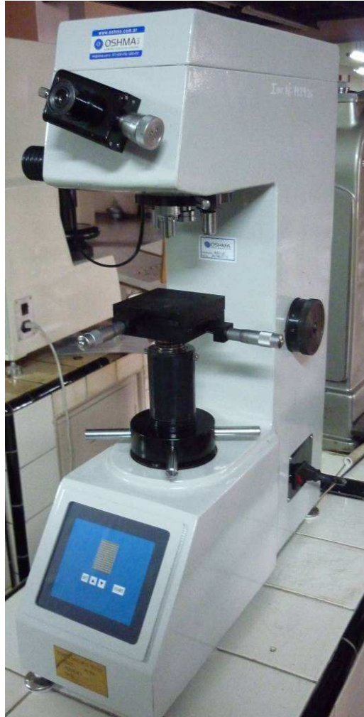
Fig. 4.2. Durómetro Vickers, modelo HV-50A (LEEM-UNS).
