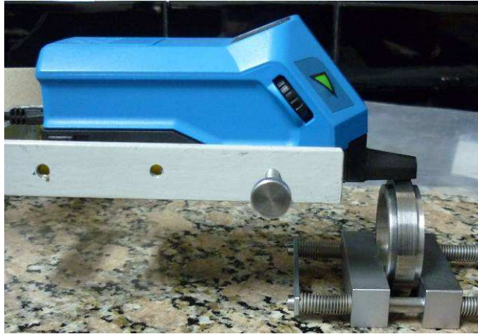
Fig. 4.7. Perfilómetro 2D marca Hommel, modelo T500 (LEEM-UNS).
