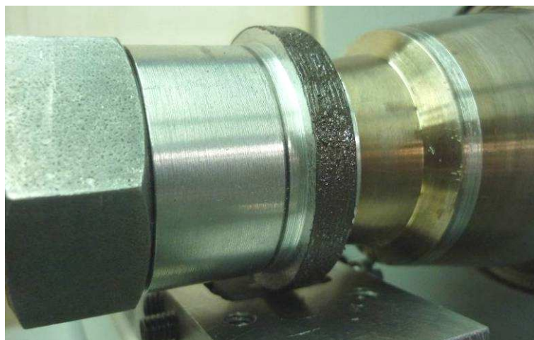
Fig. 4.20. Lubricante uniformemente aplicado sobre la superficie de contacto del anillo antes de comenzar un ciclo carga-descarga.
