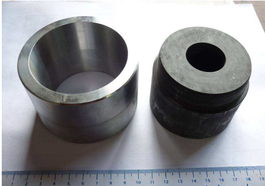
Fig. 9.5. Imágenes de las probetas confeccionadas. Izq.: Copa o Box. Der.: Cono o Pin.
