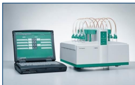
Figura 11. Equipo Rancimat ® marca Metrohm modelo 743.
