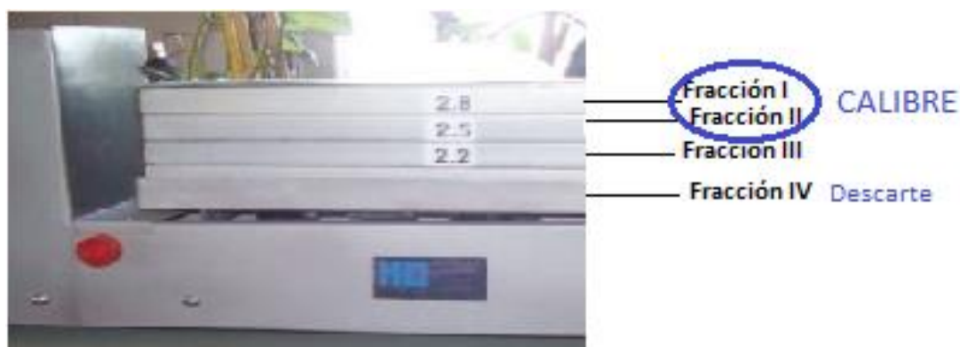
Fig. 1.8. Equipo para la determinación de calibre en granos de cebada cervecera.
