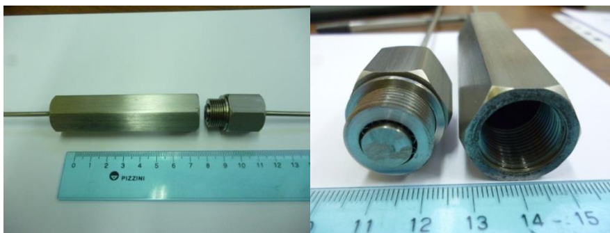
Figura 2.5. Reactor de acero inoxidable empleado para llevar a cabo la reacción con monolitos.
