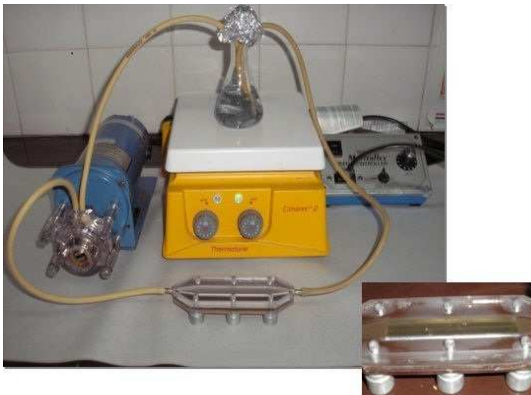
Foto 2.4 Cámara de flujo utilizada en los ensayos dinámicos de adhesión. La cámara se encuentra unida mediante mangueras de goma estériles a una bomba peristáltica que permite la recirculación de caudales en el rango de 0,1 a 1,6 \text{cm}^3/\text{seg} . La superficie de acero inoxidable estéril se coloca en el canal interior (abajo a la derecha ampliación de canal con la superficie).
