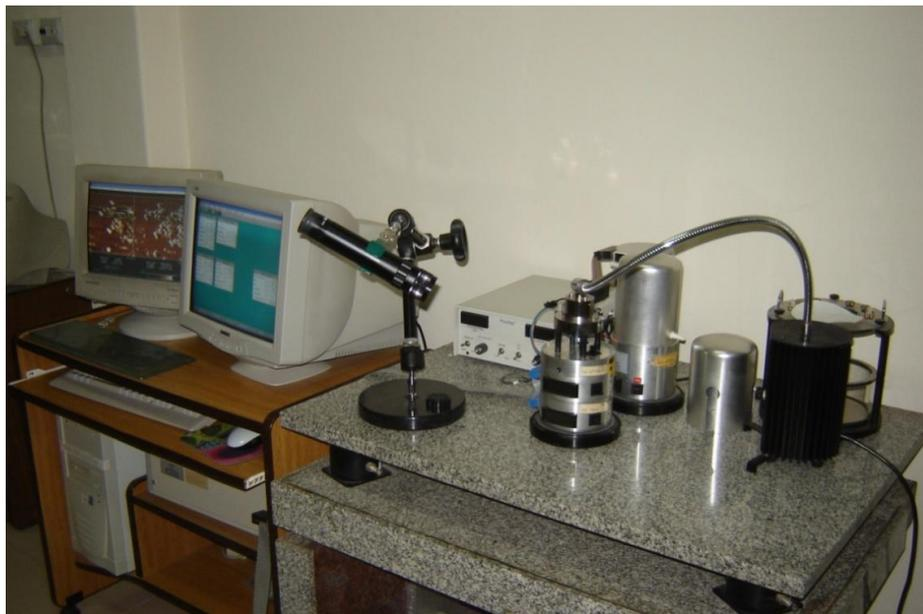
**Figura 2.12:** Fotografía del equipamiento utilizado para la medición con el STM y AFM.
