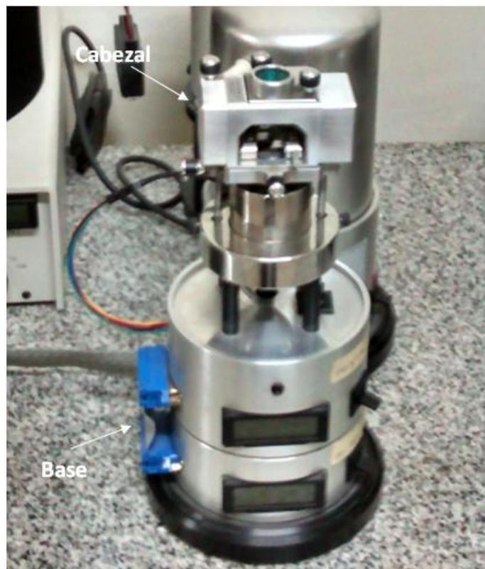
**Figura 2.9:** Fotografía de cabezal y base del AFM.
