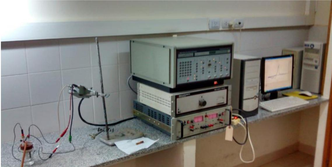
**Figura 2.2:** Fotografía del potenciostato – galvanostato controlado por computadora, utilizado en las experiencias electroquímicas.
