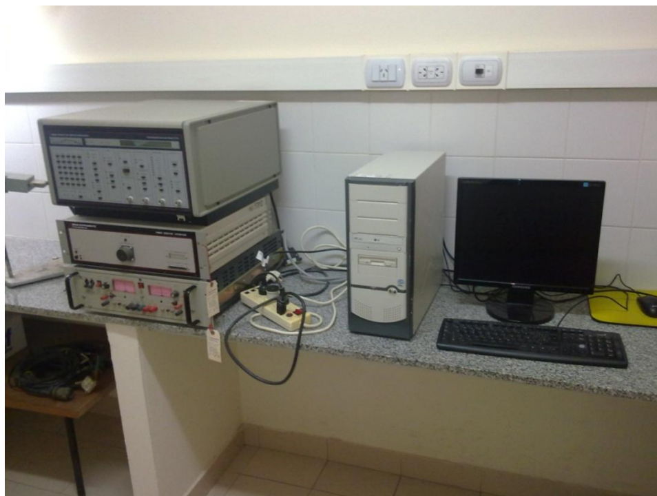
Figura 2.2: Fotografía del potenciostato – galvanostato EG&G Princeton Applied Research, modelo 273 controlado por computadora, utilizado en las experiencias electroquímicas.
