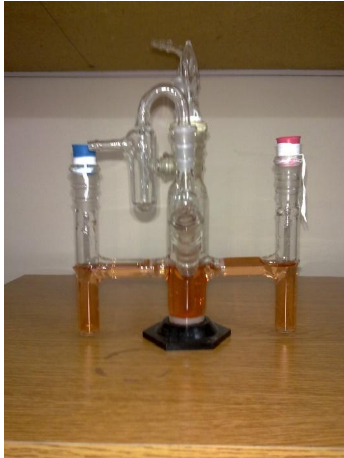
Figura 2.1: Fotografía de la celda electroquímica de tres compartimientos utilizada para llevar a cabo las experiencias electroquímicas.
