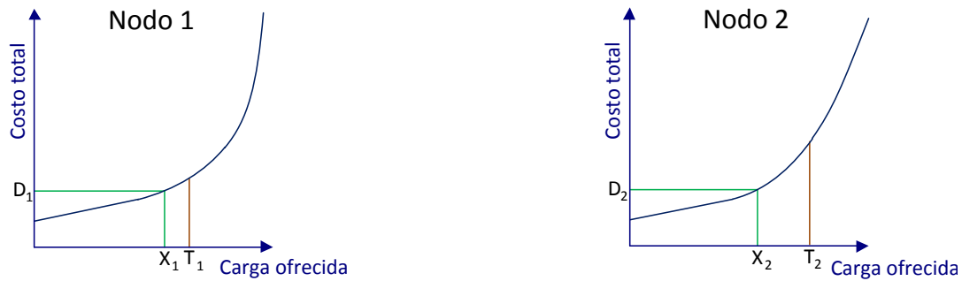
(b) Asignación aceptable. Para cada nodo, la carga X_i se encuentra por debajo de un umbral predefinido T_i .
