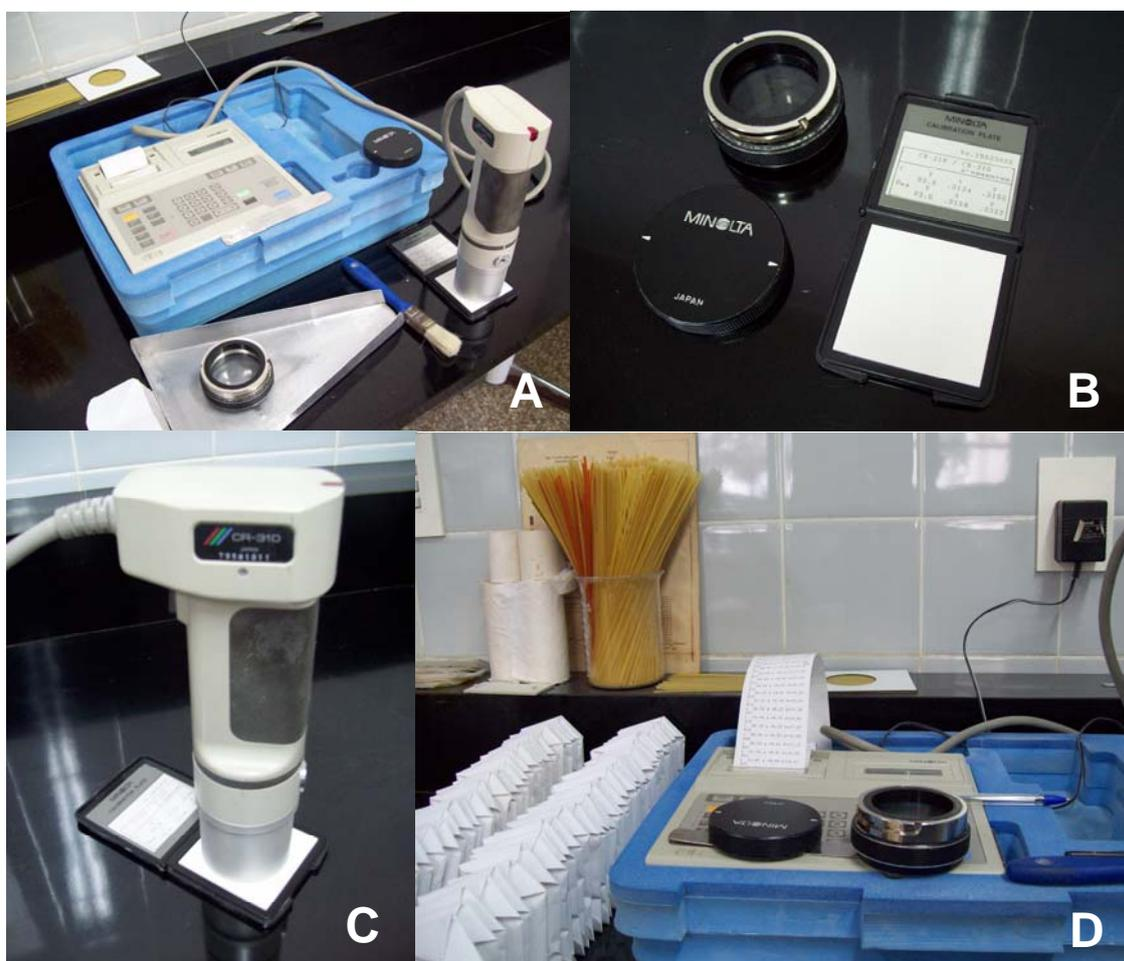
**Figura 10:** Equipo colorímetro Minolta CR-310 (A). Plato de calibración de blanco y recipiente contenedor (B). Cabezal de medición de color (C). Muestras de harina y equipo Minolta (D).
