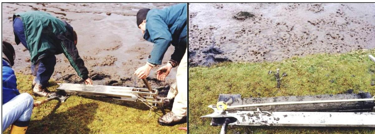
Figura 9. Izquierda: detalle del muestreador tipo Ruso (Wardenaar). Derecha: detalle del testigo muestreado
