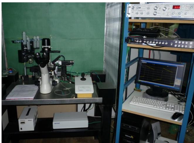
Fig. 18: Equipo de *Patch-clamp* utilizado en el laboratorio.
