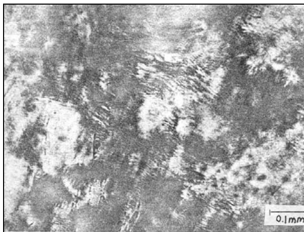
Figura 3.13 Mesofase hexagonal. Textura no geométrica con estriaciones, en muestra gruesa. Emulgente PV-15 40% en agua, 20 °C, polaroides cruzados [66].
