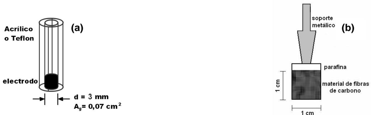
Figura 2.1 Esquemas de: un electrodo plano (a), y un electrodo de material de fibras de carbono (b).
