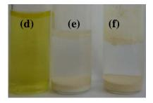
**Figura 2. 34.** Estudio del mecanismo de intercambio durante la preparación de Au/Nb<sub>2</sub>O5. Solución precursora 10<sup>-2</sup>M (a) y (d), N300 (b) y N800 (c) luego de tres horas de intercambio, N300 (e) y N800 (f) luego del lavado al NH<sub>3</sub>.
