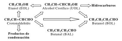
**Figura 3. 27.** Hidrogenación de crotonaldehído en fase gaseosa sobre catalizadores Au/CeO<sub>2</sub>. Esquema de reacción.
