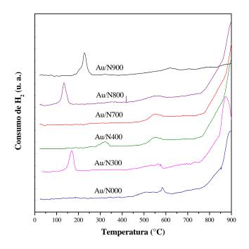
Figura 4. 4. Perfiles TPR de los catalizadores Au/Nb<sub>2</sub>O<sub>5</sub>.
