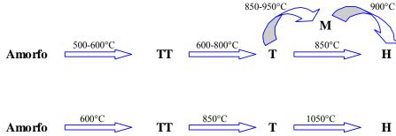
**Figura 2. 15.** Evolución de la estructura cristalográfica de Nb<sub>2</sub>O<sub>5</sub> con la temperatura [69].
