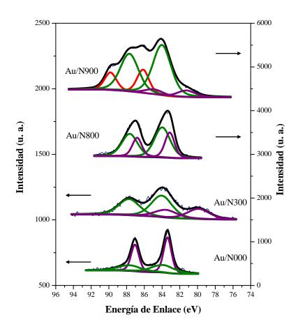
**Figura 4. 12.** Espectro XPS de la región Au 4f de Au/N000, Au/N300, Au/N800 y Au/N900.
