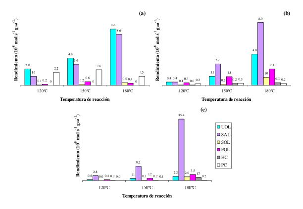
Figura 3. 18. Efecto de la temperatura de reacción. Rendimiento hacia los distintos productos.
