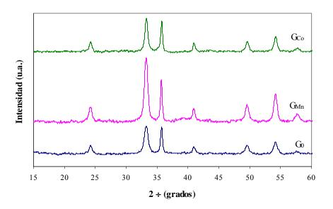
Figura 2. 28. Difractogramas de las muestras post-DTA.
