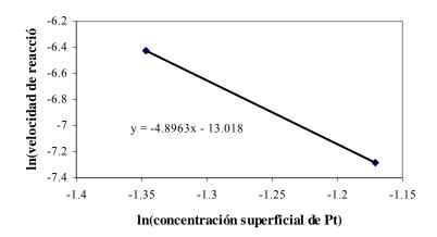
Figura A. 2. Catalizadores Pt/Al<sub>2</sub>O<sub>3</sub>. Test de Madon-Boudart
