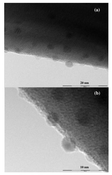
Figura 4. 9. Micrografía HRTEM de Au/N700. (a) Partículas y (b) detalle del encapsulamiento.
