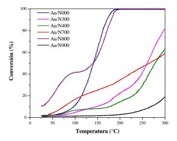
Figura 4. 16. Oxidación de CO sobre catalizadores Au/Nb<sub>2</sub>O<sub>5</sub>.
