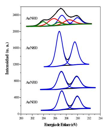
Figura 4. 15. Espectro XPS de la región Nb 3d de Au/N000, Au/N300, Au/N800 y Au/N900. 2° barrido.
