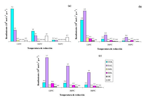
**Figura 3. 17:** Hidrogenación de crotonaldehído sobre (a) Au/CeO<sub>2</sub>240, (b) Au/CeO<sub>2</sub>150 y (c) Au/CeO<sub>2</sub>80. Efecto de la temperatura de reducción sobre los distintos rendimientos.
