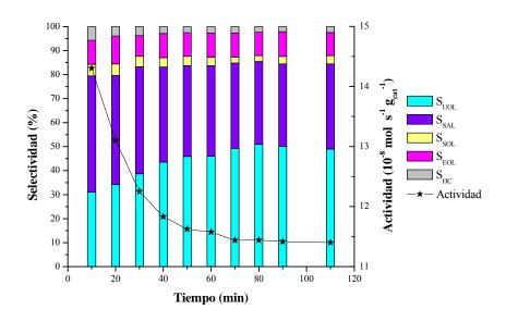
**Figura 6. 1.** Hidrogenación de crotonaldehído sobre Au/Al<sub>2</sub>O<sub>3</sub>. Evolución de la Actividad y las Selectividades en el tiempo.
