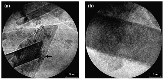
Figura 5. 3. Micrografías TEM de Au/G<sub>Co</sub> mostrando (a) una partícula de oro y (b) un detalle del soporte
