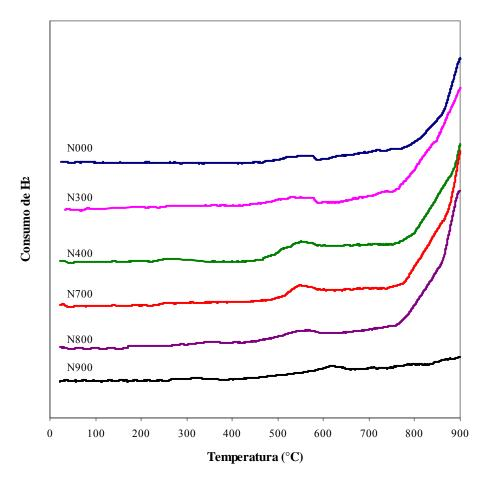
Figura 2. 22. Perfiles TPR de los soportes Nb<sub>2</sub>O<sub>5</sub>
