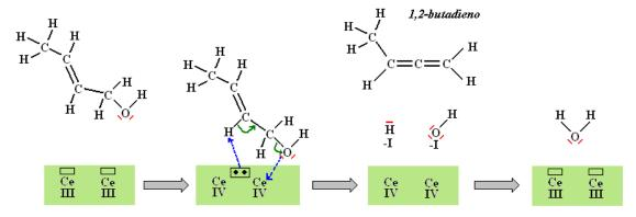
Figura 3. 23. Formación de hidrocarburos. Mecanismo redox.
