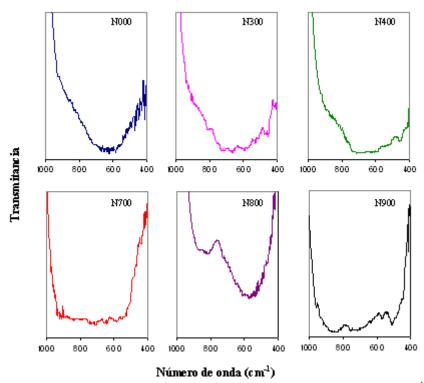
**Figura 2. 20.** Espectros FTIR de los soportes Nb<sub>2</sub>O<sub>5</sub> en la región 400-1000 cm<sup>-1</sup>.
