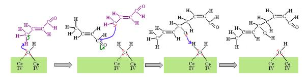
Figura 3. 25. Formación de los productos de condensación. Mecanismo de la condensación aldólica.
