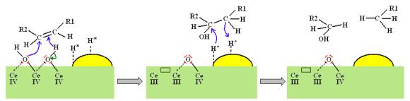
Figura 3. 24. Formación de etanol. Mecanismo de reacción
