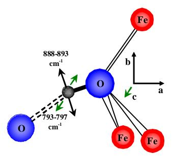
**Figura 2. 30.** Entorno del átomo de hidrógeno en la estructura de la goetita (las vibraciones del OH se indican con flechas).
