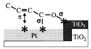
**Figura 1. 9.** Forma de adsorción del crotonaldehído sobre Pt/TiO<sub>2</sub> en estado SMSI, propuesta por Englisch *et al.* [30]
