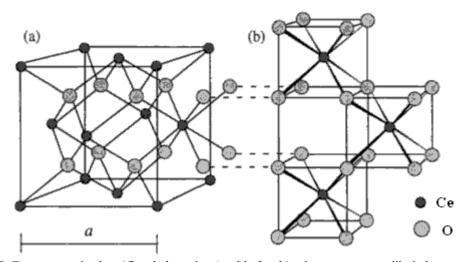
**Figura 2. 9.** Estructura cristalográfica de la ceria. a) celda fcc, b) misma estructura dibujada como un arreglo cúbico de oxígenos [53].
