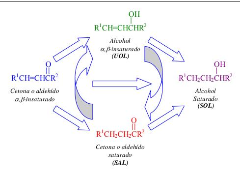
**Figura 1. 6.** Esquema de la hidrogenación de un compuesto carbonílico  $\alpha,\beta$ -insaturado.
