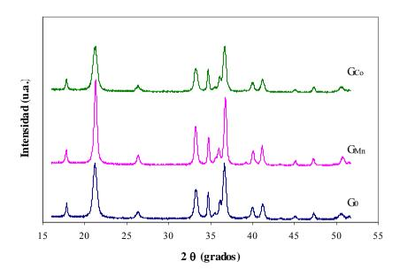
Figura 2. 24. Difractogramas de las goetitas puras y sustituidas [76].
