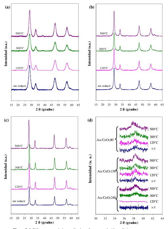
**Figura 3. 1.** Difractogramas de los catalizadores frescos y reducidos a distintas temperaturas. (a) Au/CeO<sub>2</sub>40, (b) Au/CeO<sub>2</sub>150, (c) Au/CeO<sub>2</sub>80, (d) plano (111) del oro.
