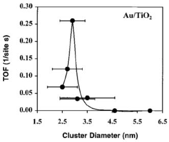
Figura 4. 17. Dependencia de la actividad en la oxidación de CO con el tamaño de las partículas de Au [6].
