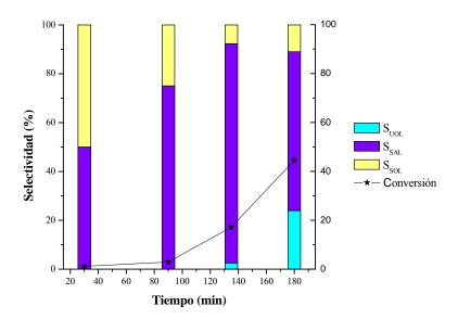
**Figura 5. 7.** Hidrogenación de crotonaldehído en fase líquida sobre Au/G<sub>Co</sub>. Evolución de la conversión y las selectividades en el tiempo.
