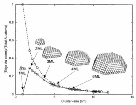
**Figura 4. 20.** Densidad de átomos en esquinas y aristas (símbolos cuadrados) y en contacto con el soporte (símbolos circulares) [9].
