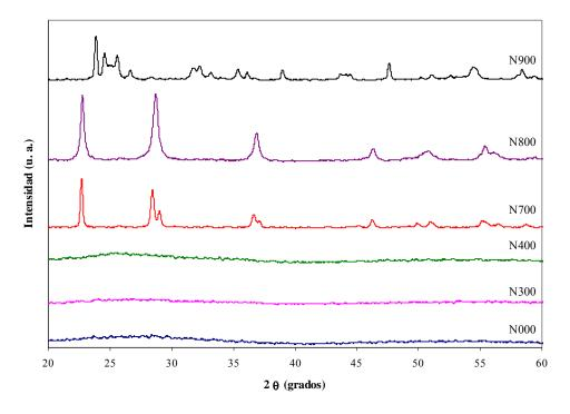
Figura 2. 16. Difractogramas de los distintos soportes.
