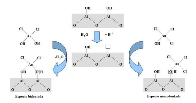
Figura 2. 6. Etapas del intercambio aniónico sobre Al<sub>2</sub>O<sub>3</sub>.
