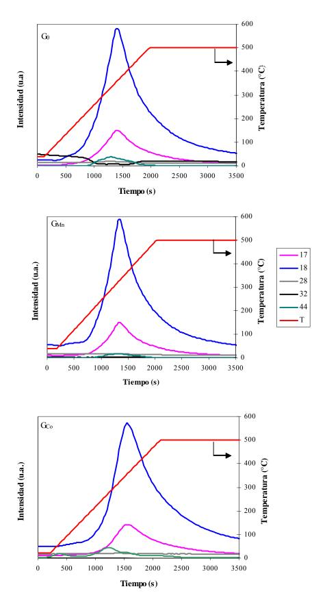
**Figura 2. 32.** Perfiles TPD de  $G_0$ ,  $G_{Mn}$ , y  $G_{Co}$ .
