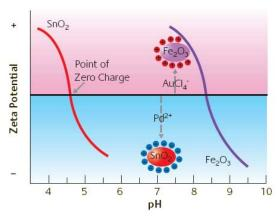
**Figura 2. 3.** Esquema de la deposición de Pd sobre  $SnO_2$  y Au en  $\alpha$ -Fe<sub>2</sub>O<sub>3</sub> [40].
