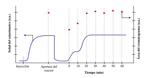
Figura 3. 9. Señal del catarómetro y área total del cromatograma durante una experiencia típica.
