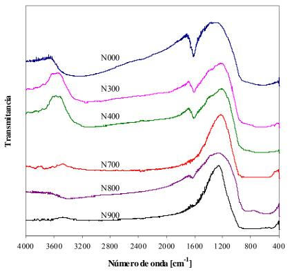
Figura 2. 19. Espectros FTIR de los soportes Nb<sub>2</sub>O<sub>5</sub>.
