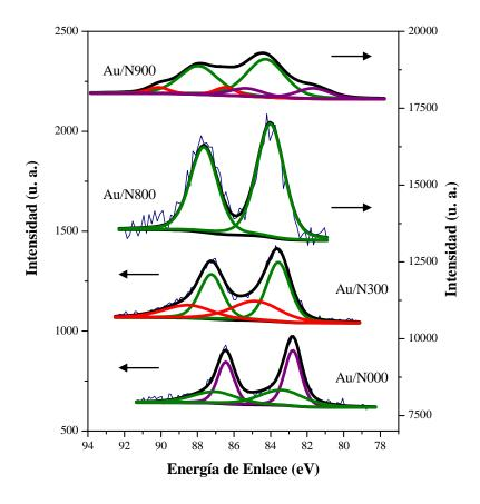
Figura 4. 13. Espectro XPS de la región Au 4f de Au/N000, Au/N300, Au/N800 y Au/N900. 2° barrido.
