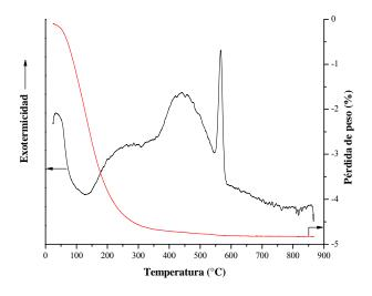
Figura 2. 18. Perfiles TGA y DTA del Nb<sub>2</sub>O<sub>5</sub>.
