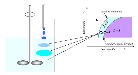
**Figura 2. 2.** Adición de un agente precipitante a una suspensión precursor-soporte. Efecto sobre la concentración local del precursor [42].
