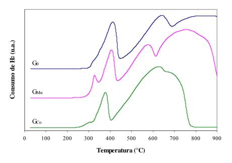
Figura 2. 31. Perfiles TPR de  $G_0$ ,  $G_{Mn}$ , y  $G_{Co}$ .
