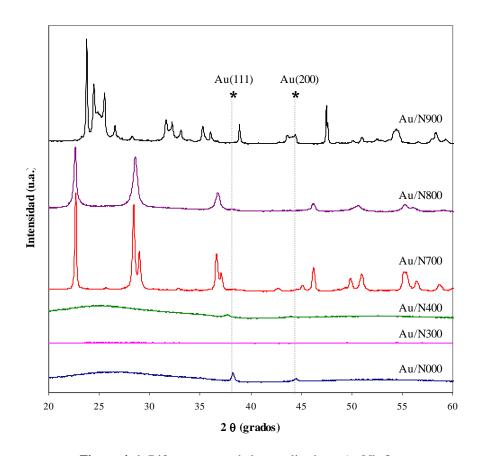
**Figura 4. 1.** Difractogramas de los catalizadores  $Au/Nb_2O_5$ .
