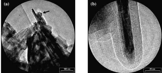
**Figura 5. 2.** Micrografías TEM de Au/G<sub>0</sub> mostrando (a) una partícula de oro y (b) un detalle del soporte.
