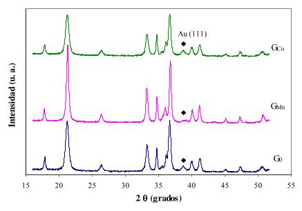
Figura 5. 1. Difractogramas de Au/G<sub>0</sub>, Au/G<sub>Mn</sub> y Au/G<sub>Co</sub>.
