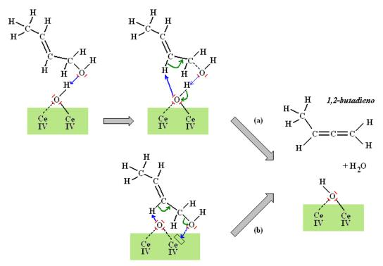
Figura 3. 22. Formación de hidrocarburos. Mecanismos ácido-base.
