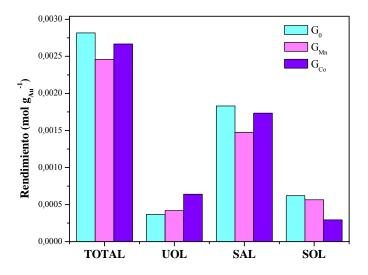
Figura 5. 6. Hidrogenación de crotonaldehído. Rendimientos totales y a los productos (3 h de reacción)
