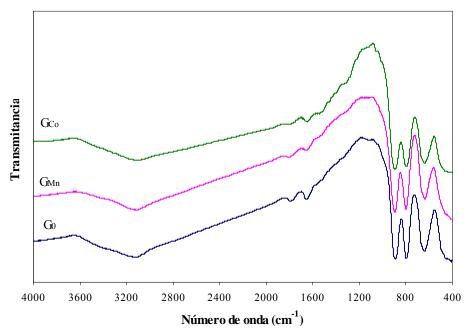
Figura 5. 4. Espectros FTIR de Au/G<sub>0</sub>, Au/G<sub>Mn</sub> y Au/G<sub>Co</sub>.
