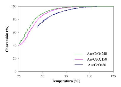
Figura 3. 8. Oxidación de CO sobre catalizadores Au/CeO<sub>2</sub>.
