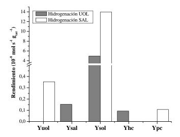
**Figura 3. 10**. Hidrogenación de butanal y alcohol crotílico. Rendimiento hacia los distintos productos (140 min).
