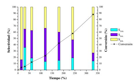
**Figura 6. 2.** Hidrogenación de crotonaldehído en fase líquida sobre Pt/ADP. Evolución de la Conversión y las Selectividades en el tiempo.
