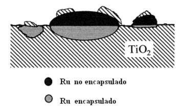
Figura 1. 8. Modelo de la apariencia de la superficie de catalizadores Ru/TiO<sub>2</sub> propuesto por Li *et al.* [74]
