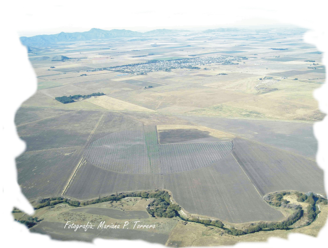
Figura 7.4. Sistema de riego por pivó empleado en cultivos de cebolla. Detrás, la localidad de Tornquist.
