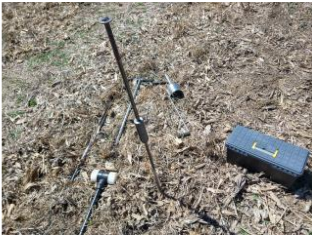
Figura 8. Muestreo de resistencia a la penetración con un penetrómetro.
