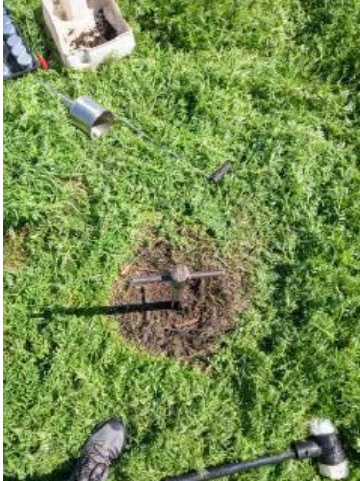
Figura 7. Muestreo de humedad de suelo mediante uso de barreno.
