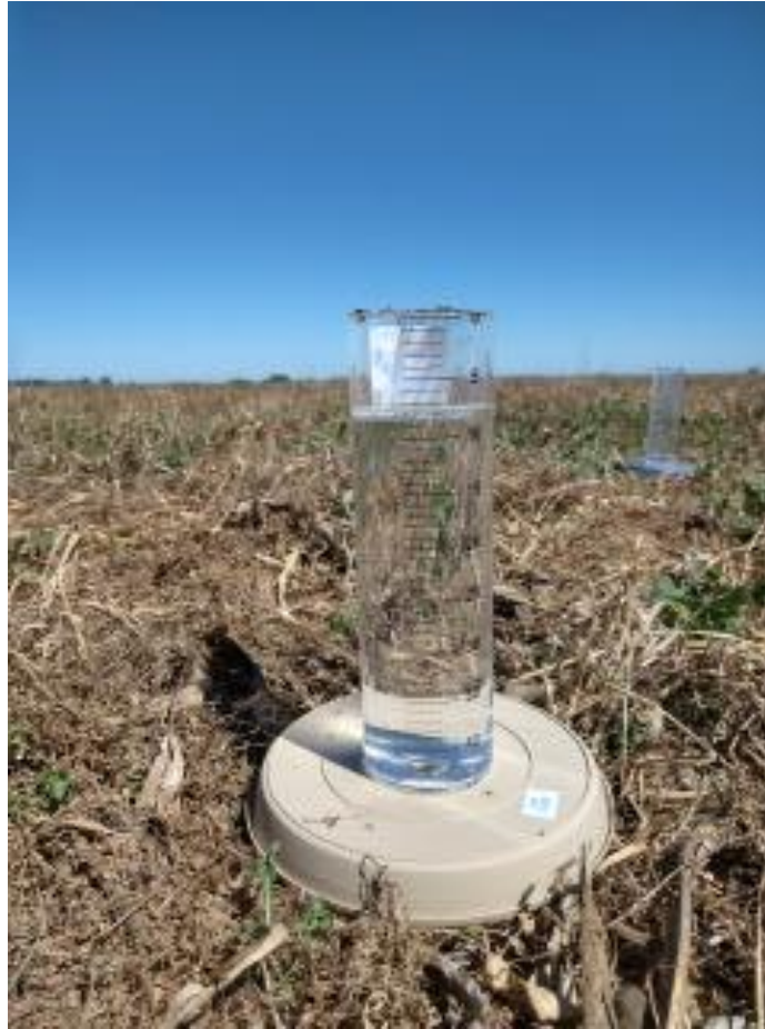
Figura 6. Infiltrómetro de anillo simple para la determinación de infiltración.
