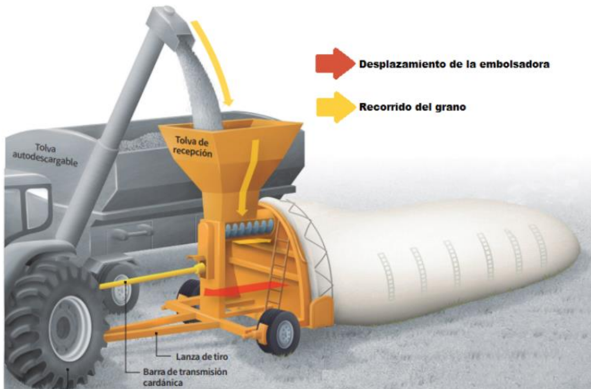
Figura 19. Ilustración procedimiento de armado de silo bolsa. (Abadia et al. , 2014)
