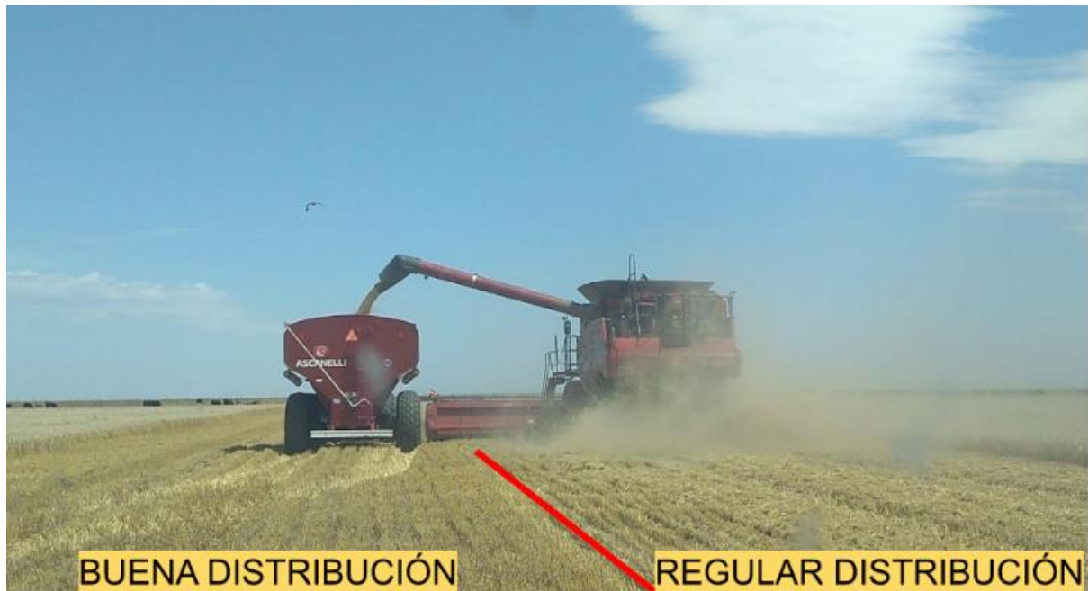
Figura 14. Distribución del residuo de cosecha en superficie.
