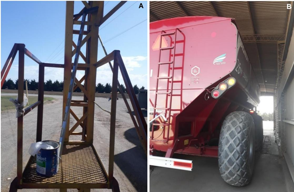
**Figura 22: A: Plataforma para calar los camiones. Se puede observar el calador y las bolsas para juntar la muestra; B: Tolva haciendo la descarga en la fosa.**
