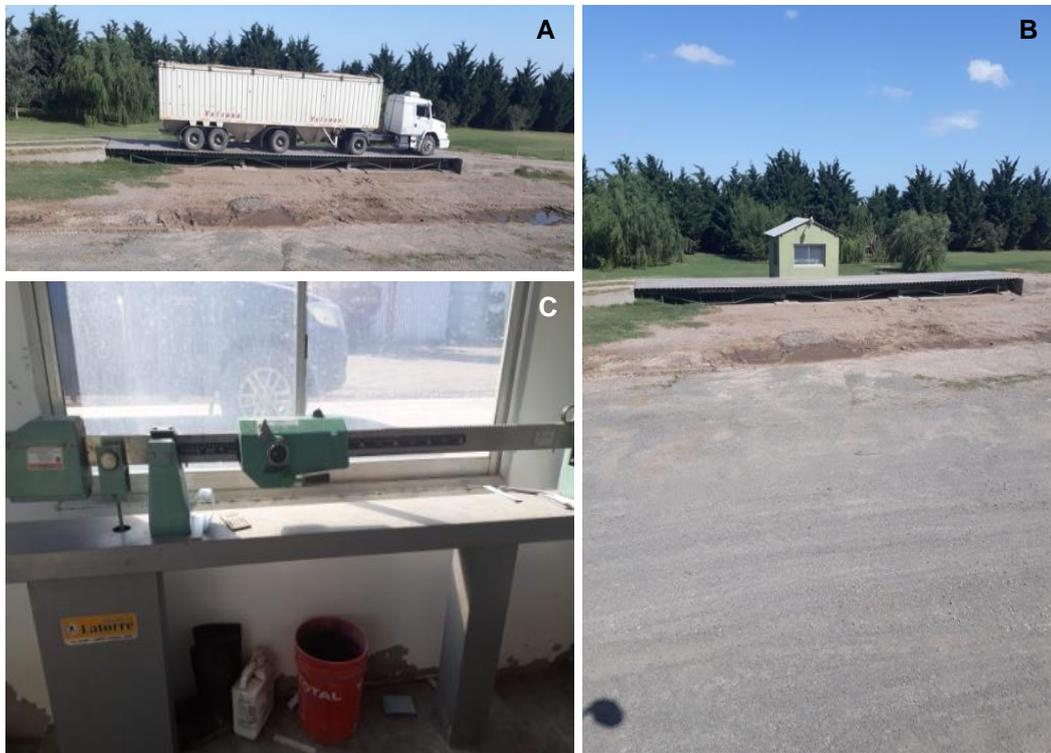
**Figura 7: A: Camión sobre la balanza; B: Balanza desde afuera; C: Balanza desde adentro.**
