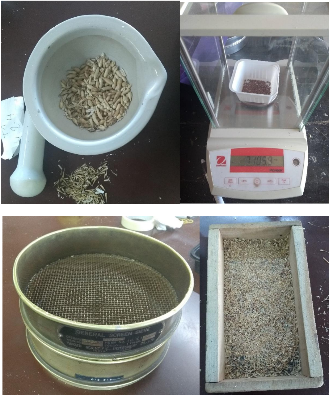
Imagen 7. Instrumentos utilizados en el laboratorio de la cátedra de Producción Vegetal Extensiva, UNS. Arriba: mortero y balanza. Abajo: zaranda y elemento para trilla manual de trigo.
