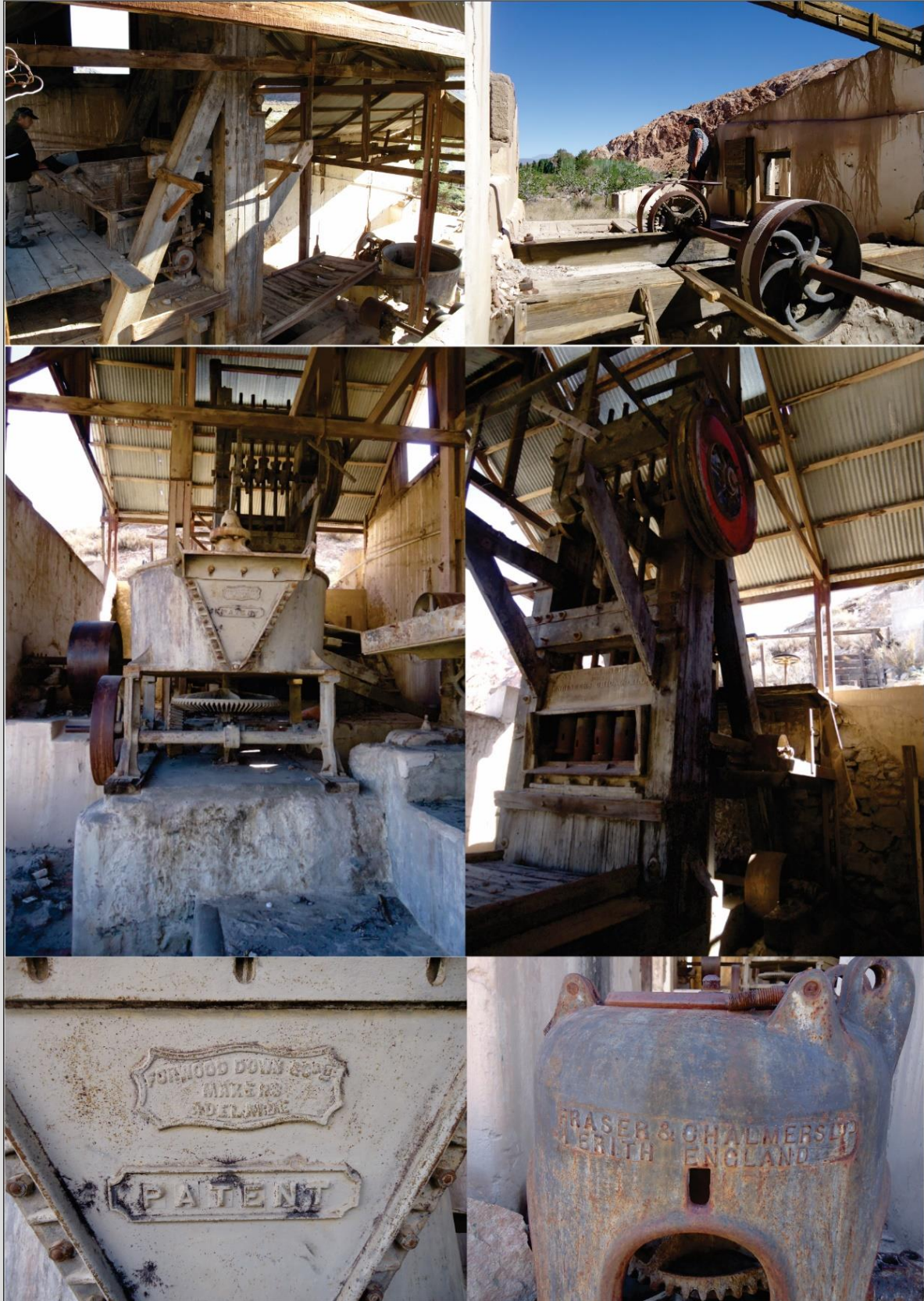
Figura 1.4. Restos de la maquinaria de principios del siglo XX instalada en Castaño Nuevo. Las piezas de fundición provienen en su mayoría de Inglaterra y Australia. El movimiento de cada una de las piezas era impulsado por la fuerza del agua, lograda a partir de un circuito de canales y compuertas desviados del curso principal del Río Castaño (Benavidez de Albar Díaz, 2007a).
