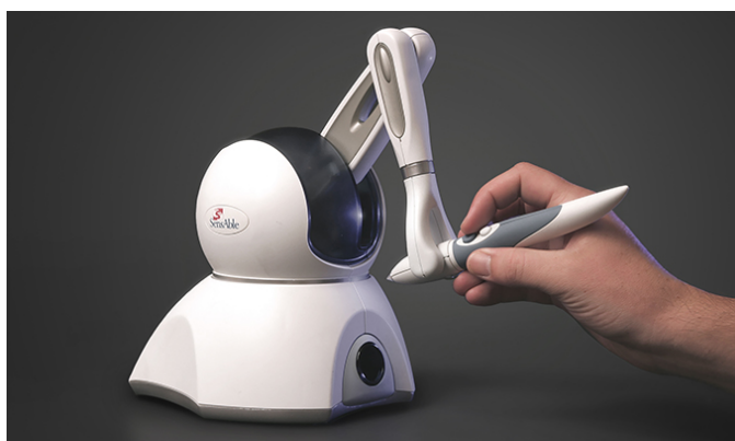
Figura 7.2: Phantom Omni, sistema de trackeo y respuesta háptica ([340]).
