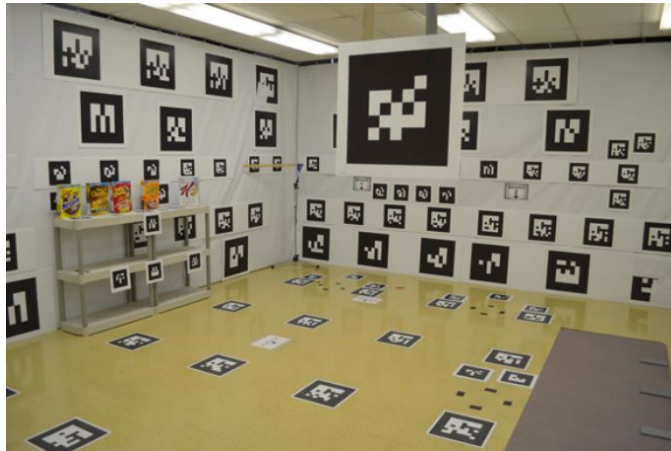
Figura 7.21: Espacio físico con marcadores en las paredes y en el piso ([418]). De esta forma el sistema puede trackear la posición del usuario en cualquier punto de la habitación.
