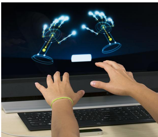
Figura 7.12: Sistema Leap Motion para trackeo preciso de la mano y los dedos del usuario.
