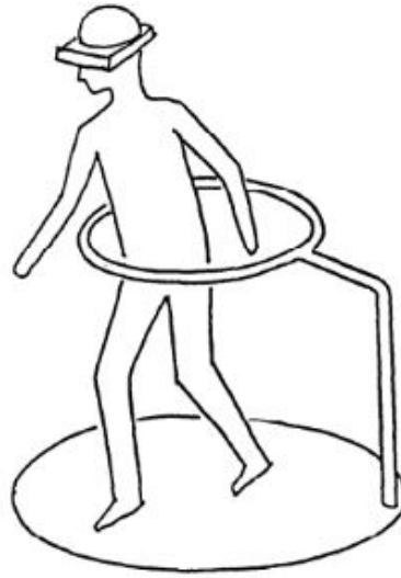
Figura 7.28: Boceto del Virtual Perambulator, una de las primeras plataformas para caminar en RV ([462]).
