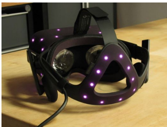
Figura 7.3: Vista de los LEDs infrarrojos del Oculus Rift CV1 con los cuales el sistema trackea su posición y rotación ([380]).
