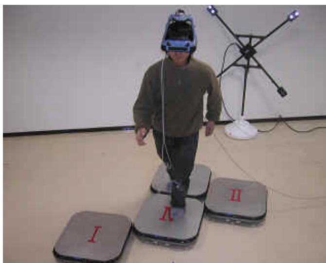
Figura 7.32: Sistema Circulafloor ([475]). Las baldosas robóticas se mueven para posicionarse justo debajo de los pies del usuario.
