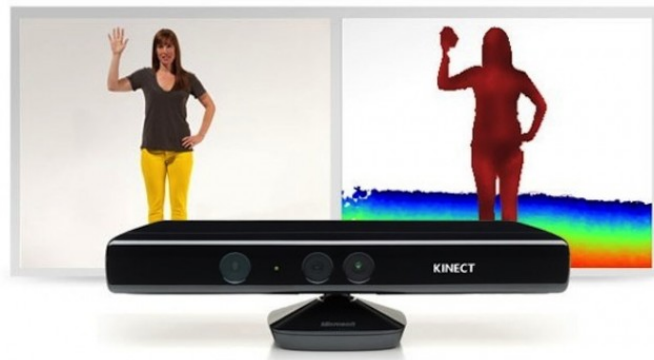
Figura 7.11: Microsoft Kinect, sistema que puede trackear la posición estimada de una persona completa.
