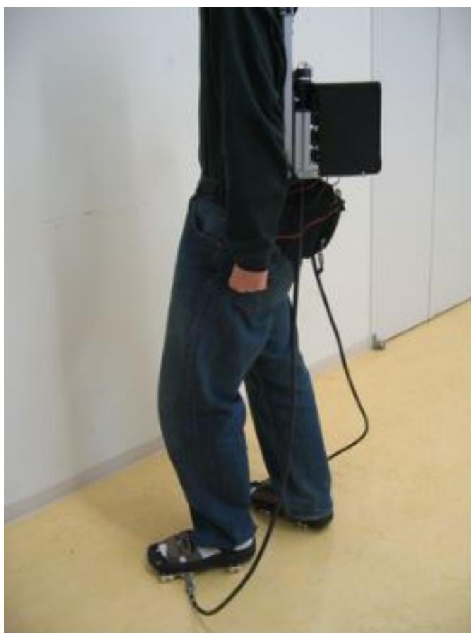
Figura 7.33: Sistema Powered Shoes ([476]). Estos patines se mueven para mantener al usuario siempre en la misma posición.
