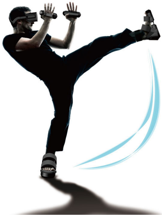
Figura 6.6: Sistema Taclim que asegura simular el contacto con distintas superficies ([358]).
