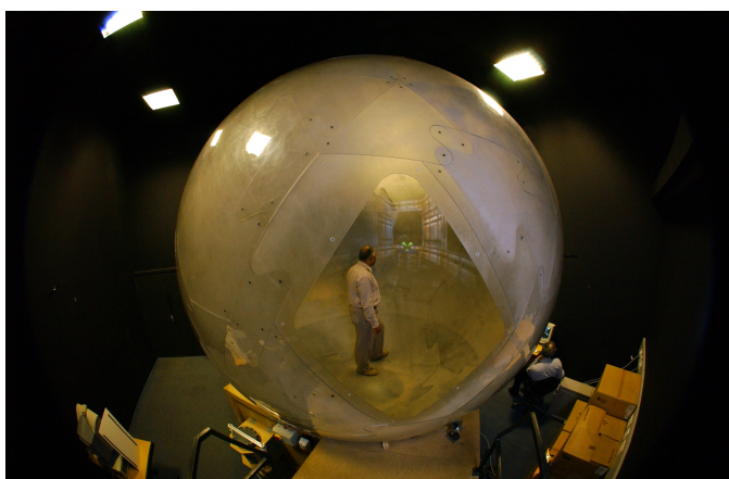
Figura 7.31: Sistema Cybersphere ([473]). El usuario camina dentro de una esfera que detecta su movimiento. La esfera también proyecta el mundo virtual sobre su superficie.
