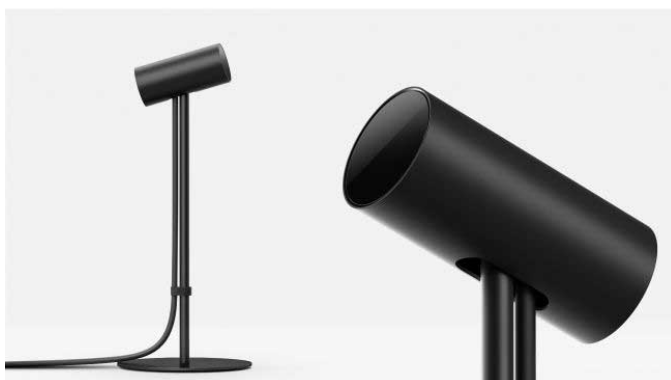
Figura 7.4: Sensor óptico del Oculus Rift que detecta los LEDs infrarrojos del HMD y de los controles ([380]).
