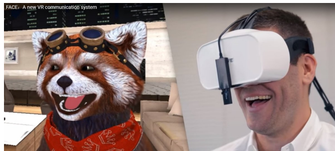
Figura 7.16: Ejemplo de detección facial del BinaryVR ([410]). Cuando el usuario sonr e, el personaje virtual tambi n lo hace acordemente.
