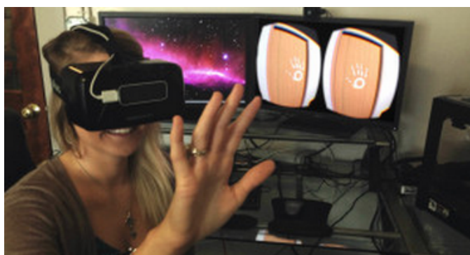
Figura 7.13: Sistema Leap Motion siendo utilizado junto con el Oculus Rift. El usuario puede ver e interactuar con sus manos en RV.
