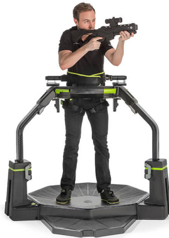
Figura 7.29: Virtuix Omni, una de las plataformas más modernas para caminar en RV ([463]).
