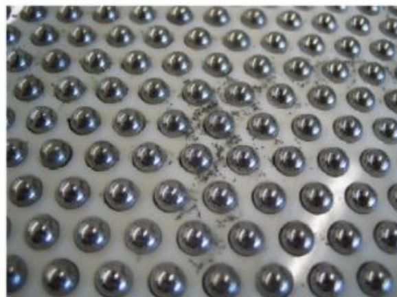
Figura 7.34: Cyberwalk ([478]). Esta plataforma está cubierta de pequeñas bolas metálicas permitiendo que el usuario deslice al caminar sobre ellas.
