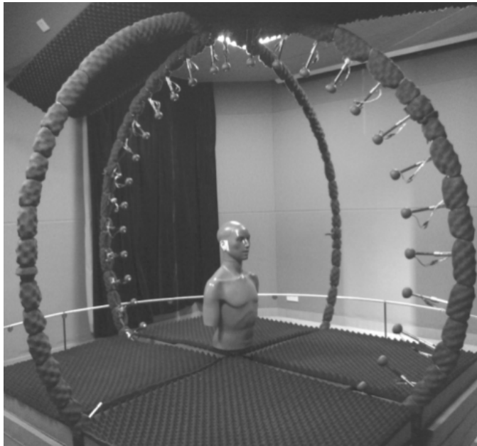
Figura 4.7: Grabación de HRTFs mediante el uso de un maniquí.
