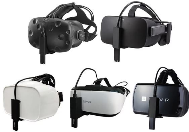
Figura 7.15: Dispositivo BinaryVR ([410]) colocado en diversos visores comerciales, demostrando su facilidad de adaptación.
