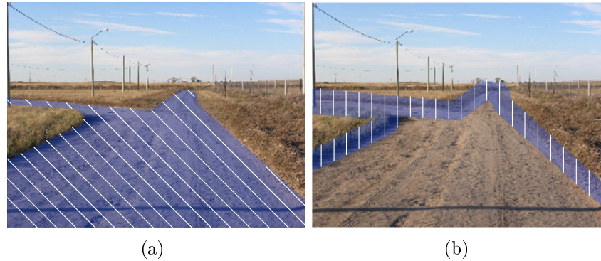
Figura 4.4: La región del camino junto a la región de los bordes para una de las imágenes del test. El mapa del camino (a) y el mapa de los bordes (b) se solapan en color azul con rayas blancas sobre la correspondiente fotografía. El ancho de la región del borde se define a partir del umbral e_{th} .
