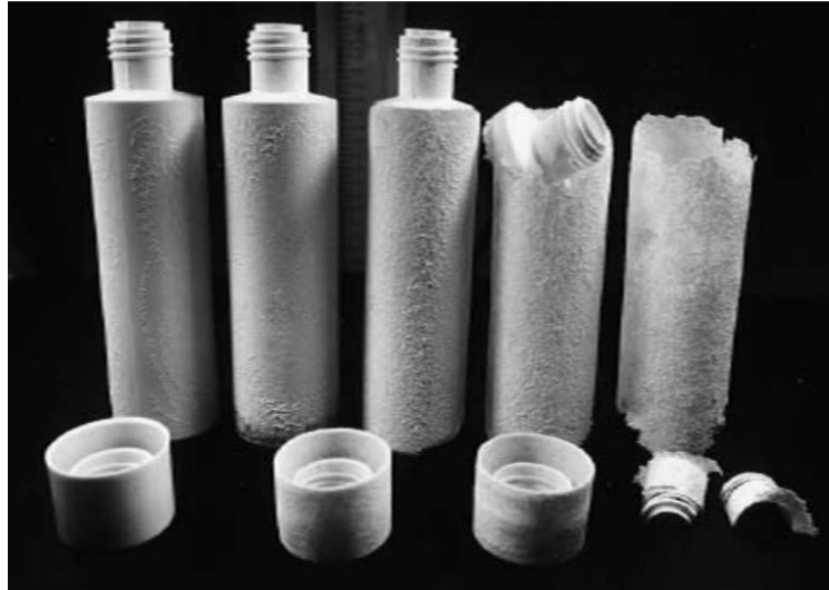
Figura 2.7. Biodegradación de PHAs. Botellas hechas de BIOPOL™ incubadas en lodos activados por 0, 2, 4, 6 y 8 semanas, respectivamente (Sudesh y col., 2000)
