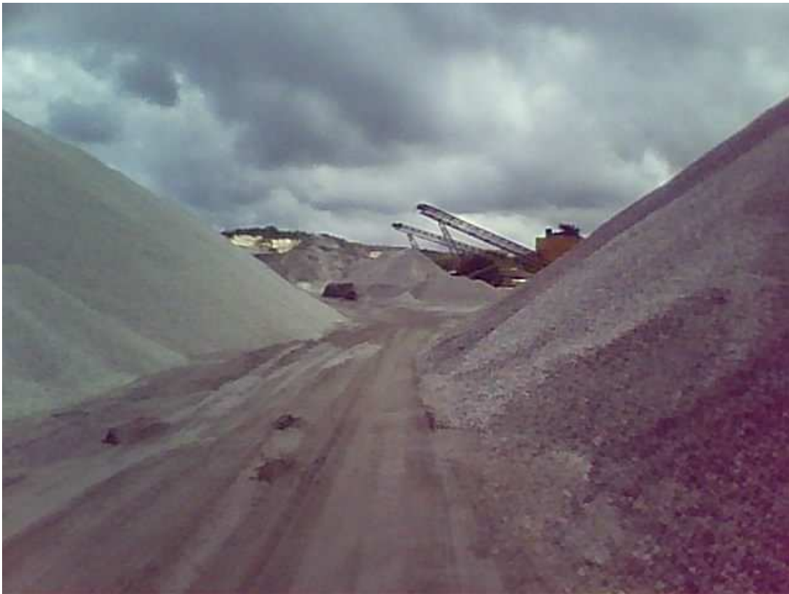
Figura N°36 Cantera San Agustín, acopio de agregados 6/19 blanco y gris
