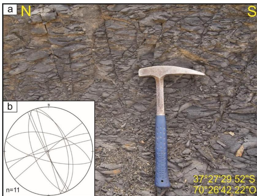
Figura 4.44. a) Afloramiento de la Formación Los Molles intensamente fracturado. b) Proyección estereográfica de las fracturas medidas en el lugar.
