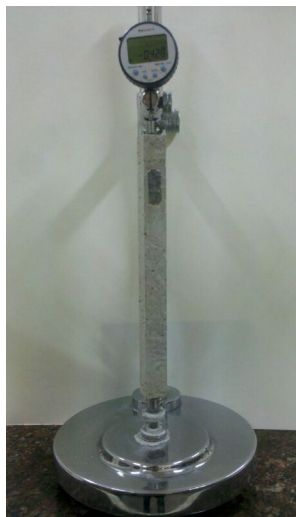
Figura 5.2: Medida de la expansión de una barra de mortero en comparador digital del Laboratorio LEMIT.
