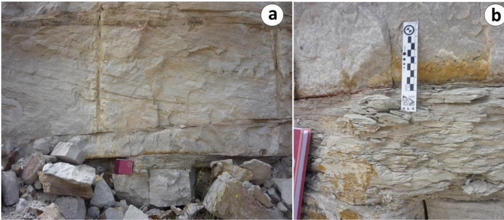
Figura 6.11: (a) Sector inferior y medio del nivel inferior de explotación, de base a techo: nivel masivo de cuarcita de 80 cm, nivel arcilloso de 30 cm, estrato masivo de cuarcita de 50 cm y estrato de cuarcita con estratificación entrecruzada de 2 m de espesor. (b) Detalle del nivel de arcillas.
