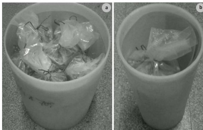
Figura 5.3: Prisma/as de hormigón acondicionados: (a) para cámara a 38°C (1 año); (b) acondicionado en un recipiente único para ser almacenado en estufa a 60°C (13 semanas).
