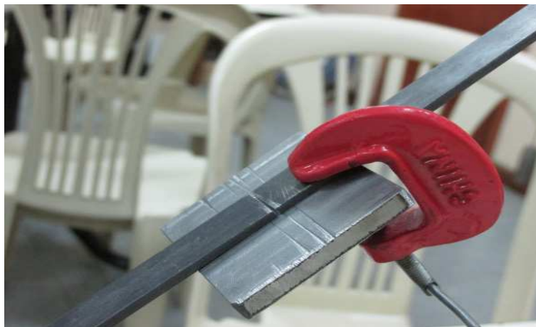
Figura 3.6: Estructura parcialmente encastrada en la hendidura de la pieza de acero.
