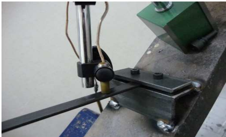
Figura 2.3: Estructura montada sobre perfil UPN 100. Pórtico biempotrado.
