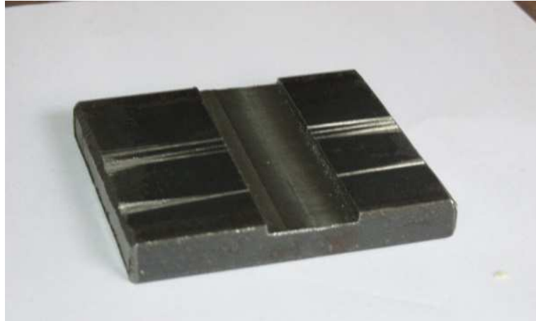
Figura 3.5: Pieza de acero para marcar la profundidad de la fisura.
