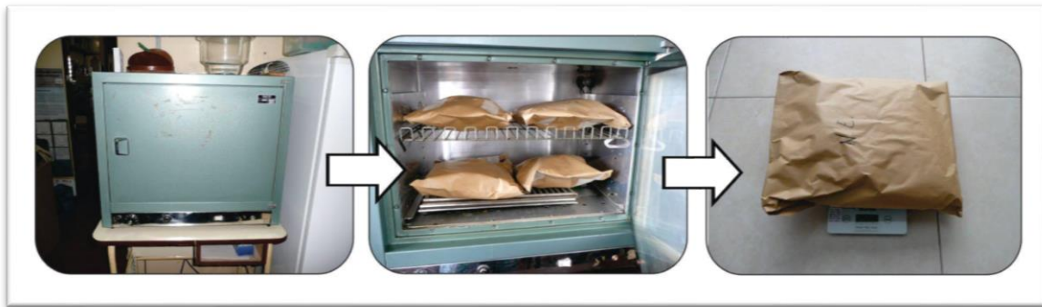
Figura 3.5. Secado y pesaje de las muestras en laboratorio
