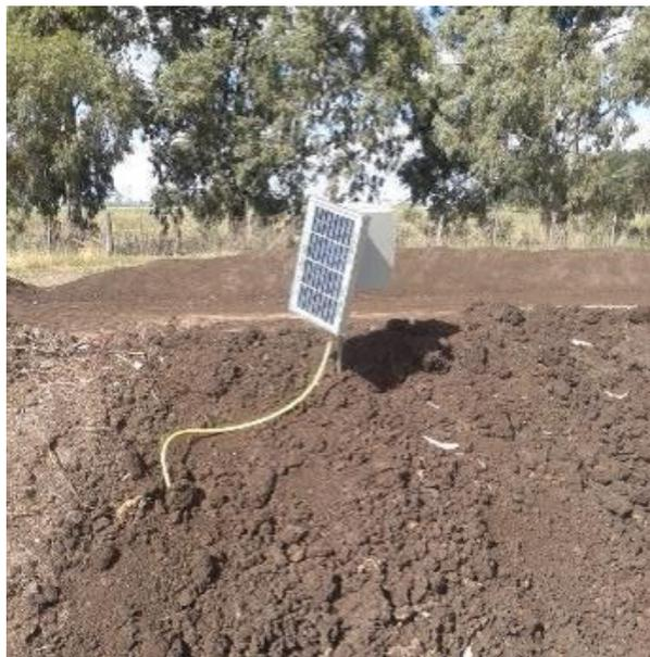
Figura 19. Sistema de sensores con telemetría en pila de compost.
