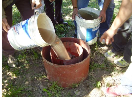
Fotografías 3 y 4: Ensayo de infiltración método de doble anillo.
