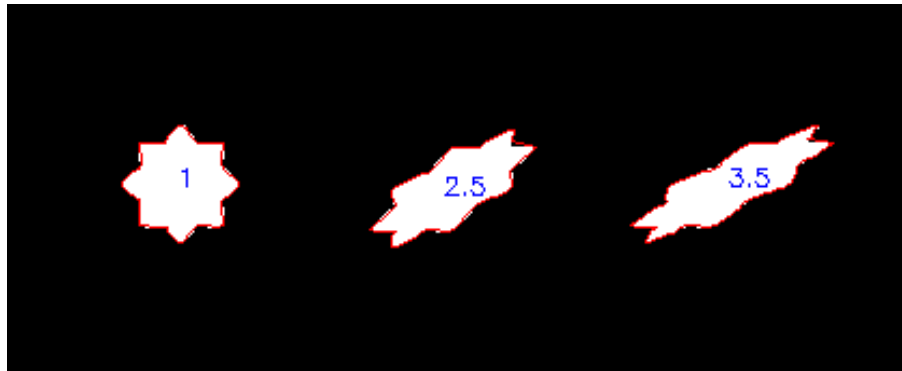
Fig. 3.6. Conjunto de figuras que tienen valores constantes en área con una leve variación en su forma, sin embargo con notables diferencias en sus valores de relación de aspecto.
